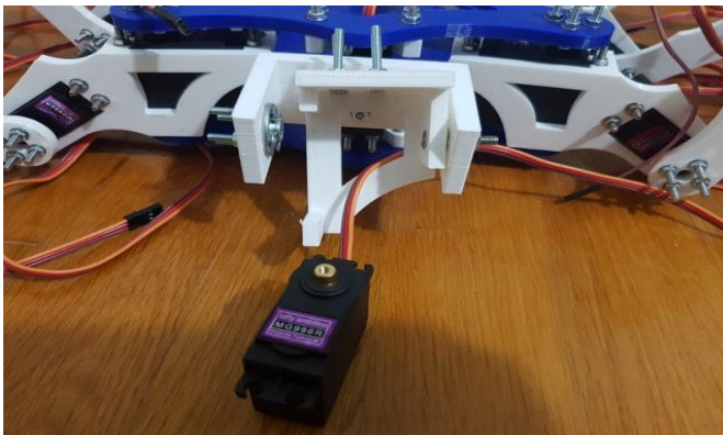
Εικόνα 11: Η σύνδεση του σερβοκινητήρα με την ουρά
