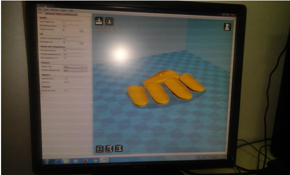
[Εικόνα 6.9.7: Χρήση του προγράμματος Cura. Φόρτωση του αρχείου coverfinger1.stl]
