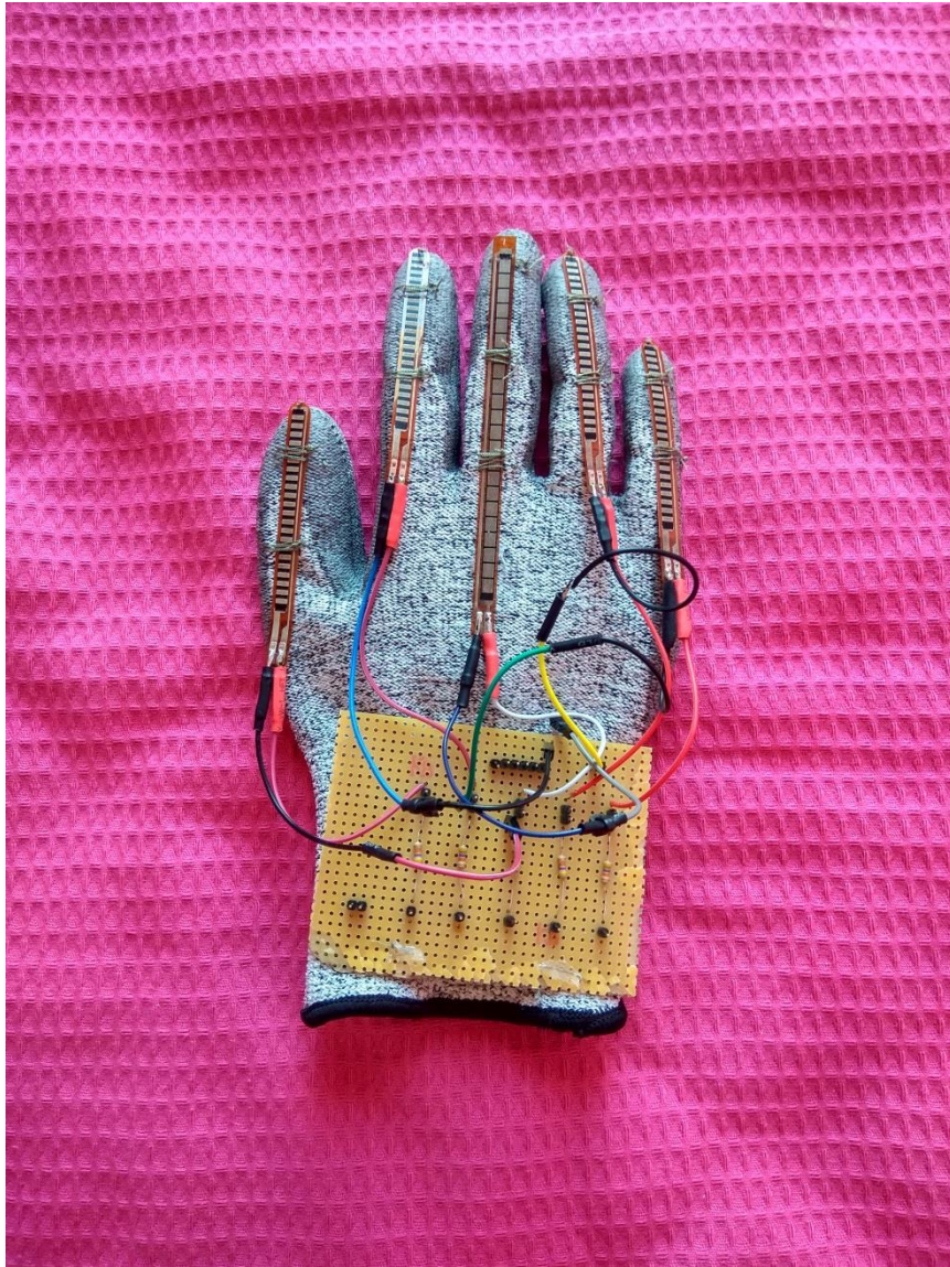
[Εικόνα 8.8.2: Ολοκληρωμένη συνδεσμολογία γαντιού]
