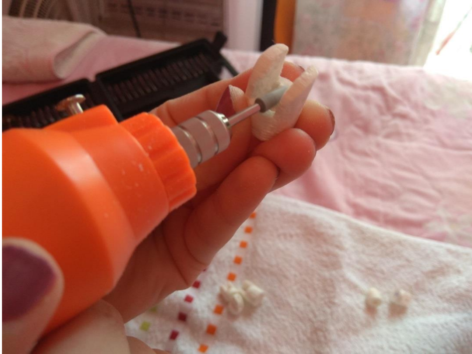
[Εικόνα 8.1.2: Λιμάρισμα άρθρωσης δακτύλου με ηλεκτρικό τρυπάνι]
