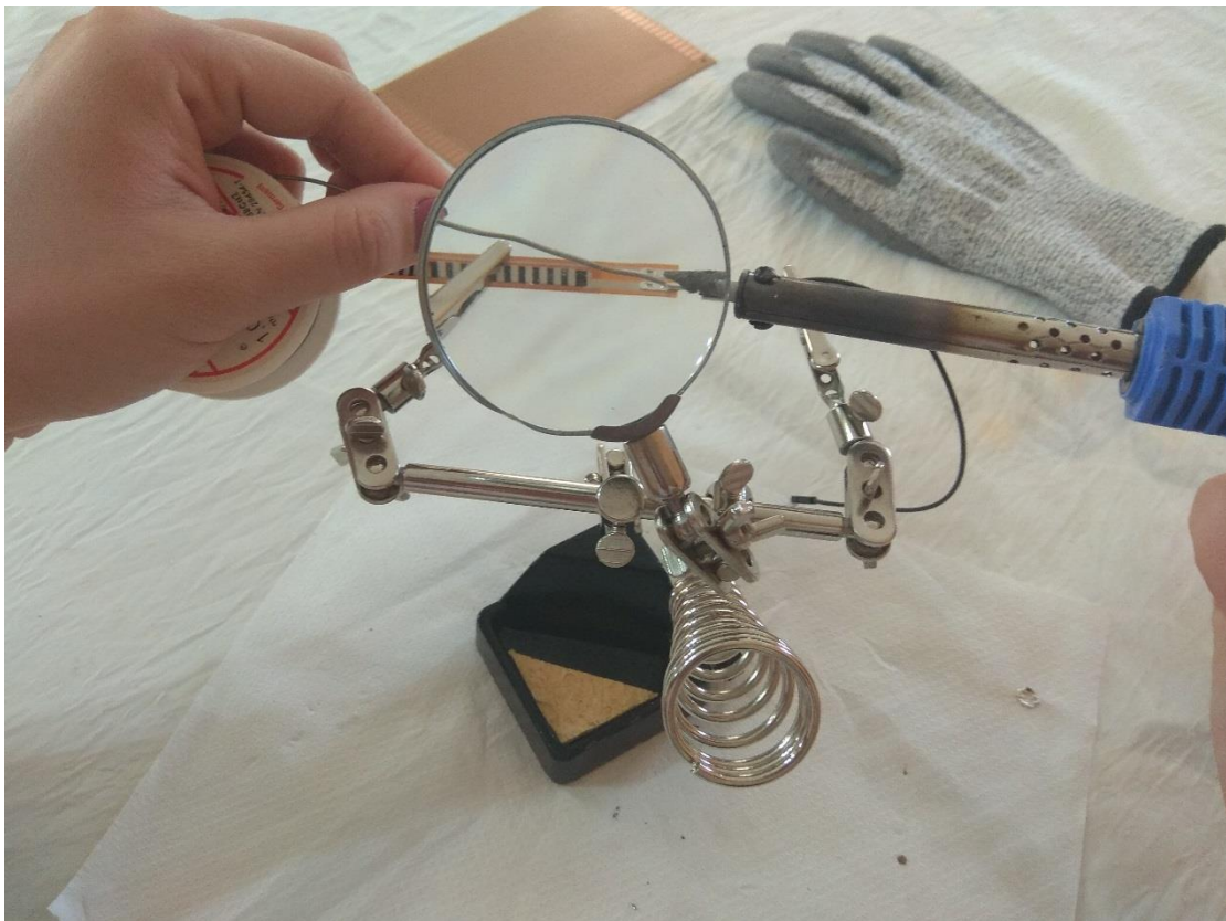
[Εικόνα 7.9: Συγκόλληση Flex αισθητήρα]
