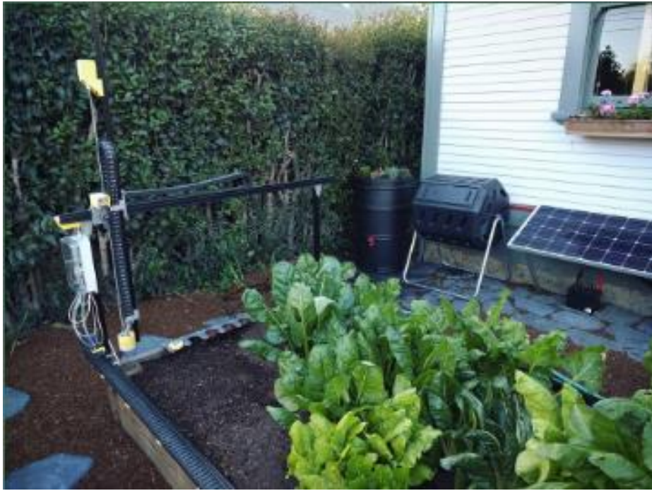
[Εικόνα 2.2: Το FarmBot με μικρές ηλιακές εγκαταστάσεις και συστήματα συλλογής βροχής / Πηγή: https://farmbot.io/ ]
