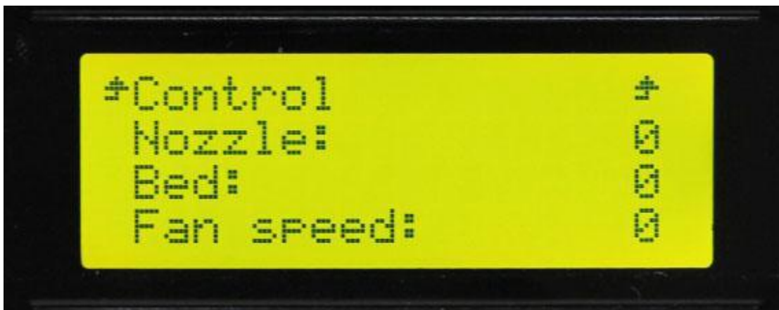
[Εικόνα 6.5.8: Έλεγχος θερμοκρασίας ακροφυσίου, κρεβατιού & ταχύτητας ακροφυσίου / Πηγή:
