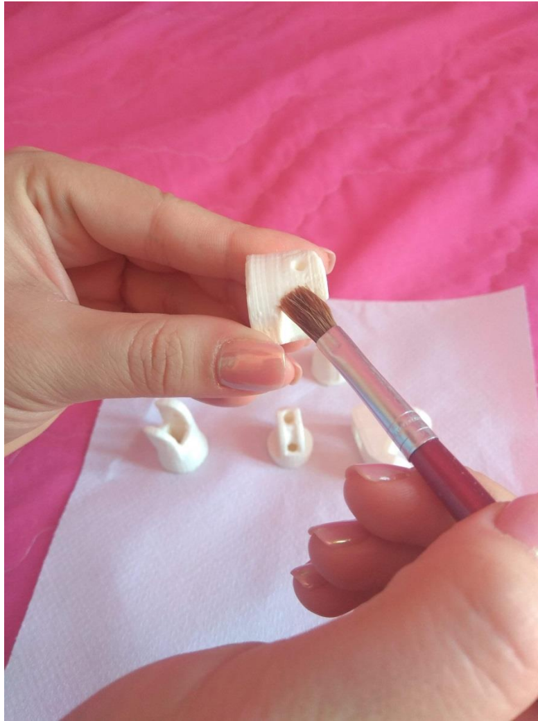
[Εικόνα 8.2.1: Χρήση ασετόν για λείανση ABS υλικού]
