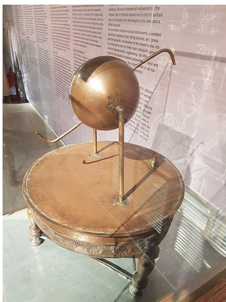
Η αιολόσφαιρα του Ήρωνα (ανακατασκευή), Τεχνολογικό Μουσείο Θεσσαλονίκης
