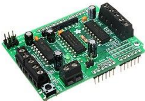
shield Adafruit με βιδωτούς ακροδέκτες για σύνδεση με κινητήρες
