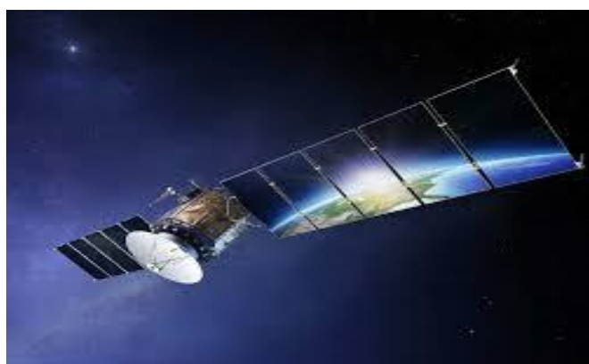
Εικόνα 5.16. Οι δορυφόροι που χρησιμοποιούνται για τηλεπικοινωνίες τροφοδοτούνται από φωτοβολταϊκά
