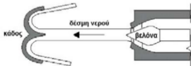
Σχήμα 3.13. Η μορφή του κάδου ενός στροβίλου Pelton η και ο άξονας του ακροφυσίου
