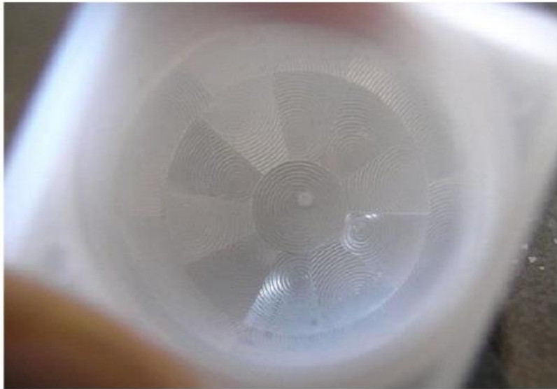
Εικόνα 13. Ο φακός τύπου Fresnel του αισθητηρίου PIR.
