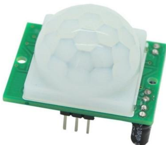
Εικόνα 11. Αισθητήριο παθητικών υπέρυθρων PIR
