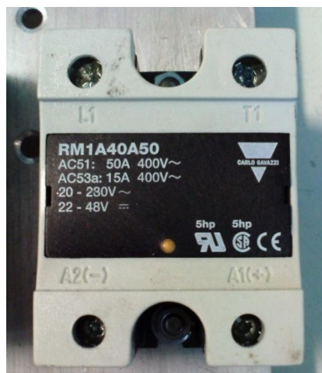
Εικόνα 57. Ρελέ στερεάς κατάστασης μιας επαφής (L1-T1) που σπλίζει με 20 έως 230 V ac ή 22 έως 48 V dc (A1-A2).
