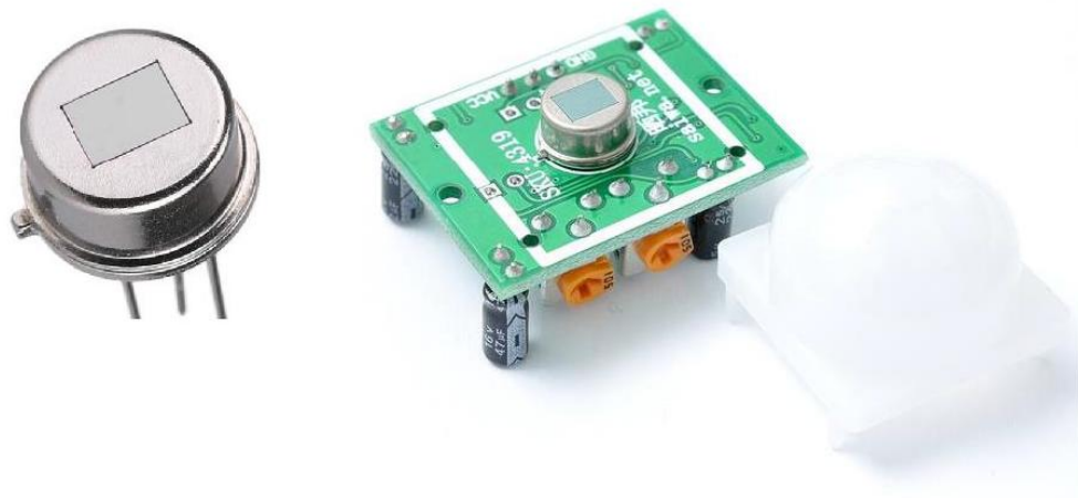
Εικόνα 12. Αισθητήριο υπέρυθρων πάνω σε κάρτα.
