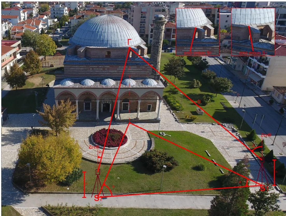
Εικόνα 81. Προσδιορισμός σημείου με τη μέθοδο της εμπροσθοτομίας.
