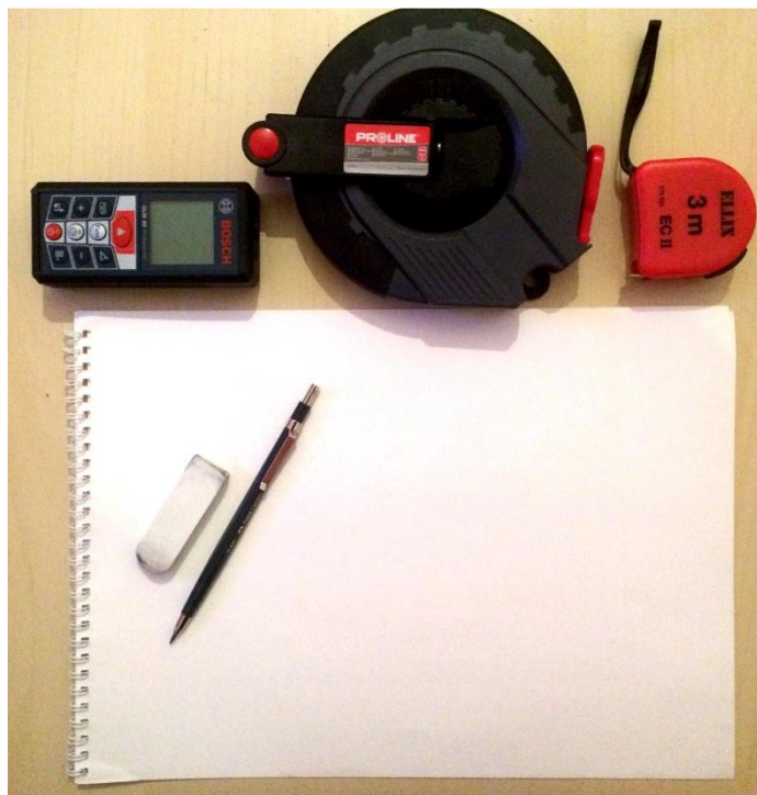
Εικόνα 76. Εξοπλισμός τοπομετρικής μεθόδου.
