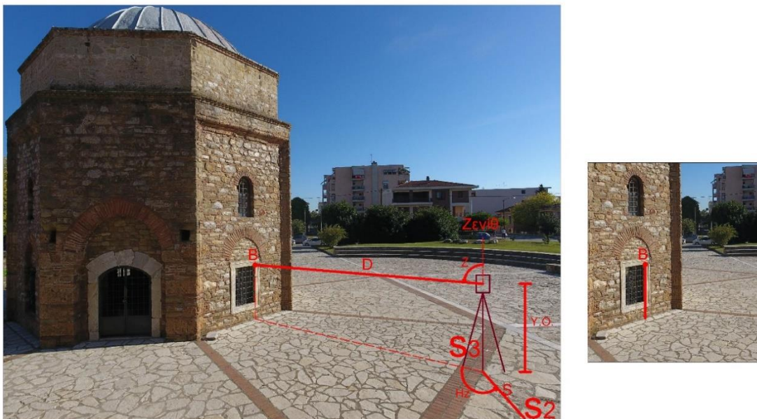
Εικόνα 80. Σύγκριση προσδιορισμού σημείου με τη μέθοδο των πολικών συντεταγμένων και την τοπομετρική.
