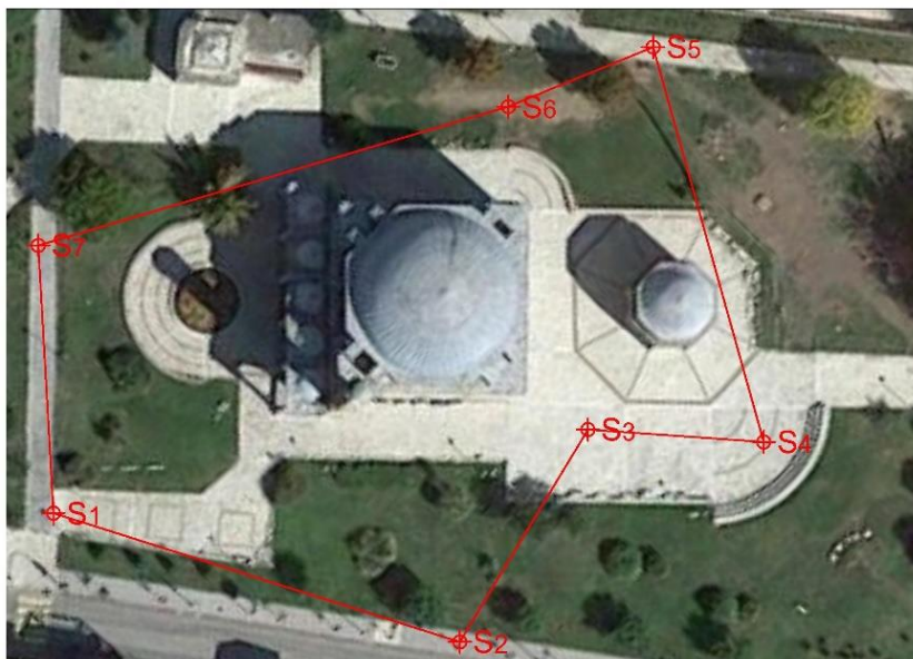
Εικόνα 75. Κλειστή εξαρτημένη πολυγωνομετρική όδευση.
