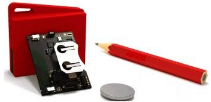
Εικόνα 30: SimpleLink™ multi-standard CC2650 SensorTag™ kit reference design[82]
