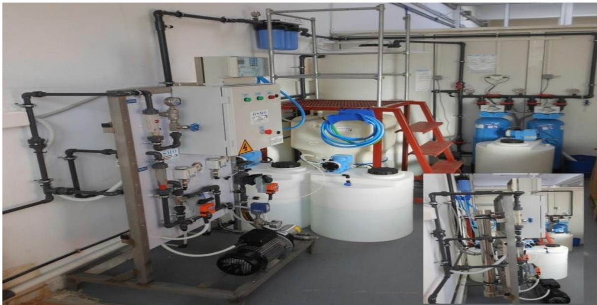
Εικόνα 8.1 Πειραματική μονάδα αφαλάτωσης αντίστροφης όσμωσης Εργαστηρίου ΗΜΕ & ΠΡΟΠΕ (Πηγή : Ποσοτικής Νικόλαος - Μελέτη και Πειραματικός Έλεγχος Επίδρασης της Αλατότητας στην Κατανάλωση Μονάδας Αντίστροφης Όσμωσης)
