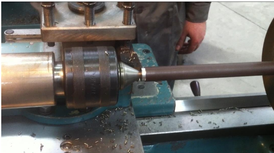
EIKONA 4.4: Επεξεργασία δοκιμίων σε τόρνο
