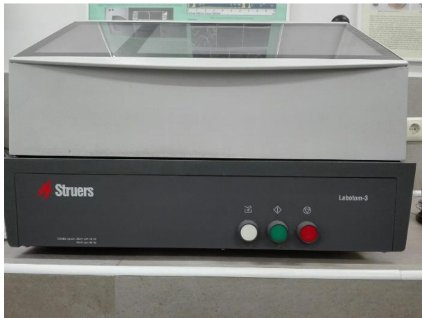
EIKONA 4.6: Κοπή των δοκιμίων σε κοπτικό Labotom-3
