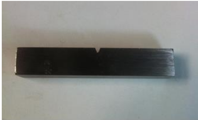
ΕΙΚΟΝΑ 4.11: Τυποποιημένα δοκίμια για την δοκιμή δυσθραυστότητας
