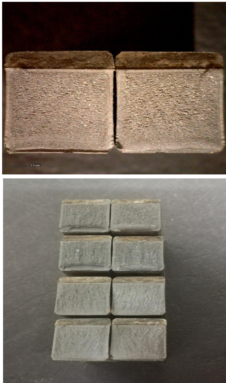
ΕΙΚΟΝΑ 7.2: Επιφάνειες θραύσης δοκιμίου Νο8 (2 ώρες ενανθράκωση)
