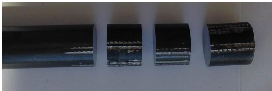
EIKONA 4.7: Κοπή των δοκιμίων για την ανάλυση στην εγκάρσια διατομή
