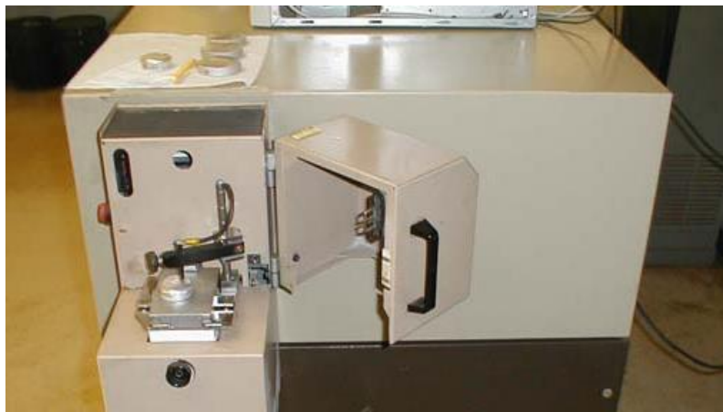
ΕΙΚΟΝΑ 4.2: Θέση Υποδοχής του δοκιμίου στο φασματογράφο
