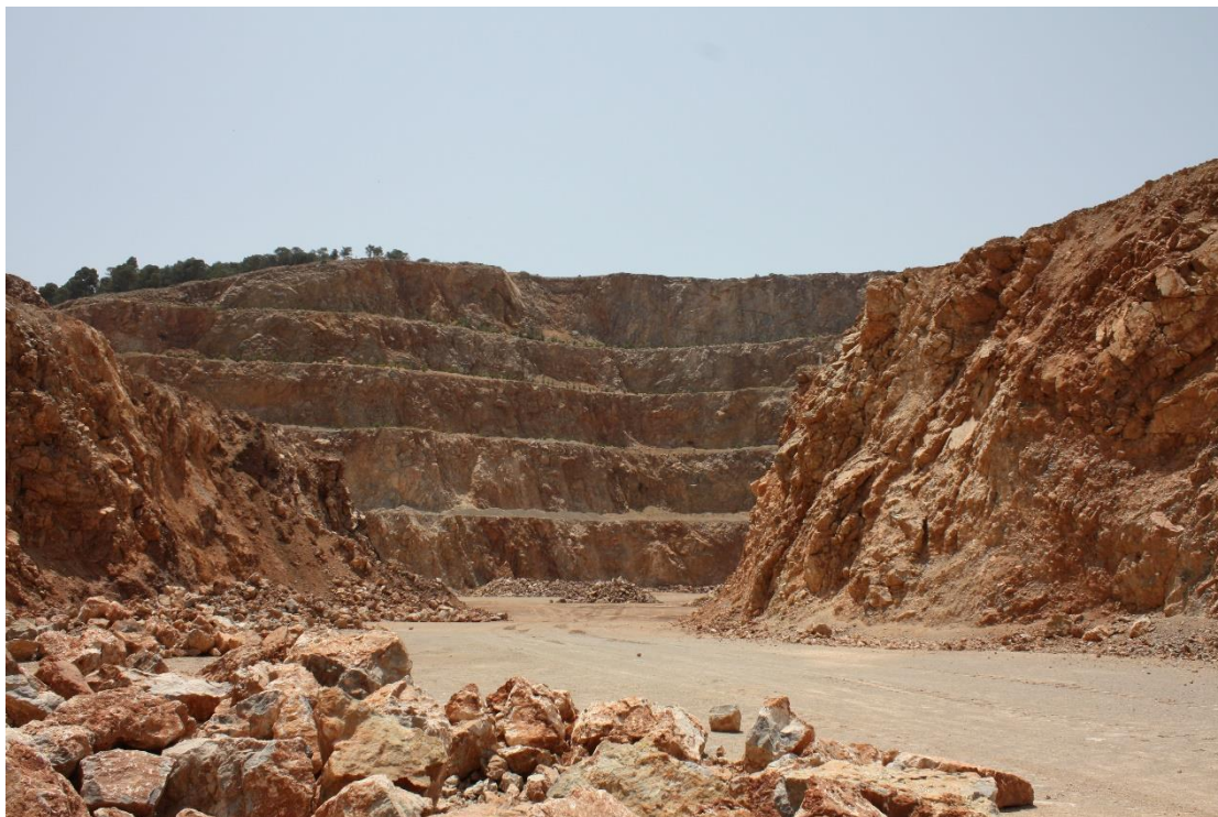
Άποψη βαθμίδων λατομείου
