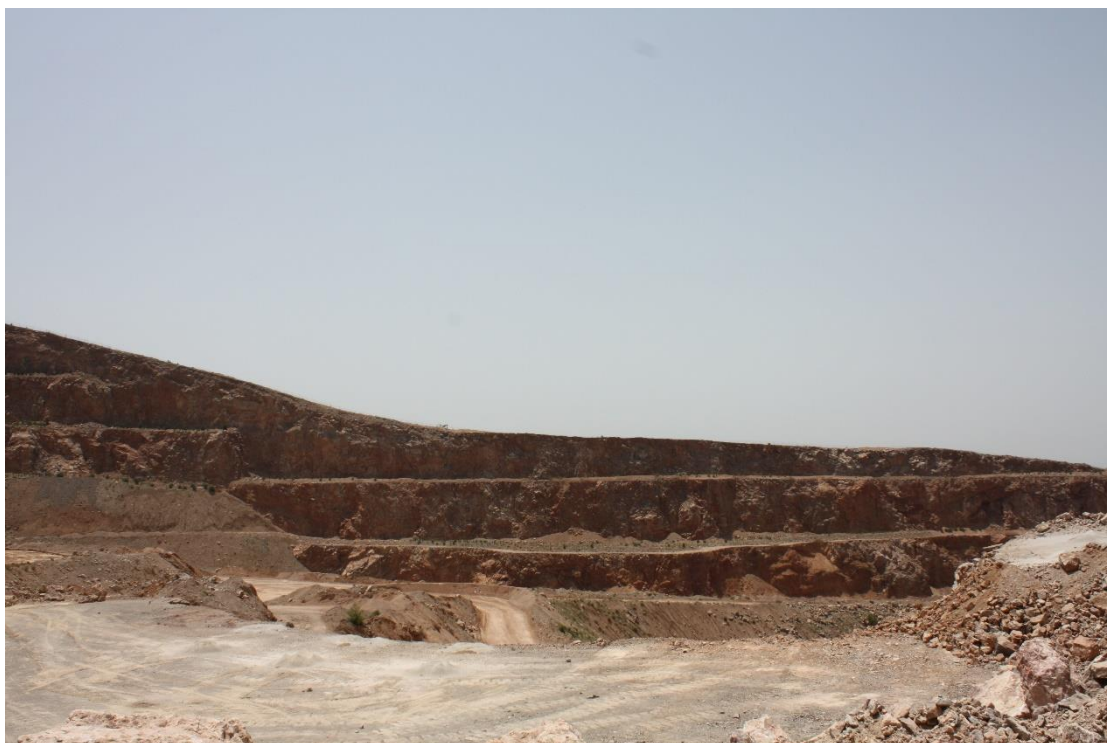
Άποψη βαθμίδων λατομείου
