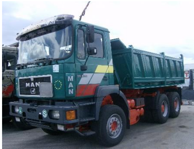
Εικόνα 2.15 : Μέγιστο επιτρεπόμενο βάρος τριαξονικού φορτηγού → 26.000 kg
