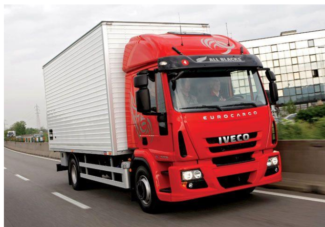
Εικόνα 2.14 : Μέγιστο επιτρεπόμενο βάρος διαξονικού φορτηγού → 19.000 kg
