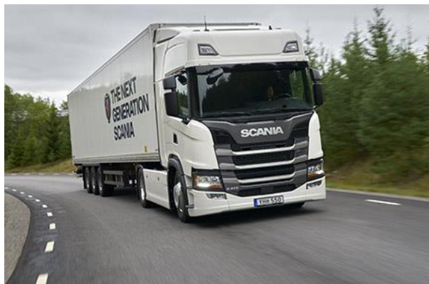
Εικόνα 2.19 : Μέγιστο επιτρεπόμενο βάρος αρθρωτού με τέσσερις ή περισσότερες άξονες → 38.000 kg
