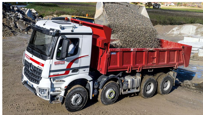
Εικόνα 2.16 : Μέγιστο επιτρεπόμενο βάρος τετραξονικού οχήματος → 33.000 kg
