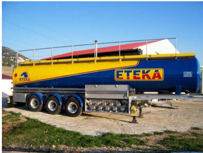
Εικόνα 2.18 : Μέγιστο επιτρεπόμενο βάρος τριαξονικού ημιρυμουλκούμενου → 32.000 kg
