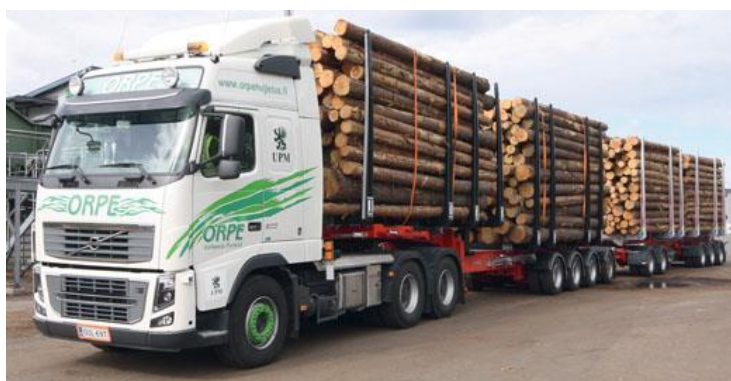
Εικόνα 2.20 : Μέγιστο επιτρεπόμενο βάρος συρμού → 38.000 kg (π.χ. τριαξονικό φορτηγό + τετραξονικό ρυμουλκούμενο).
