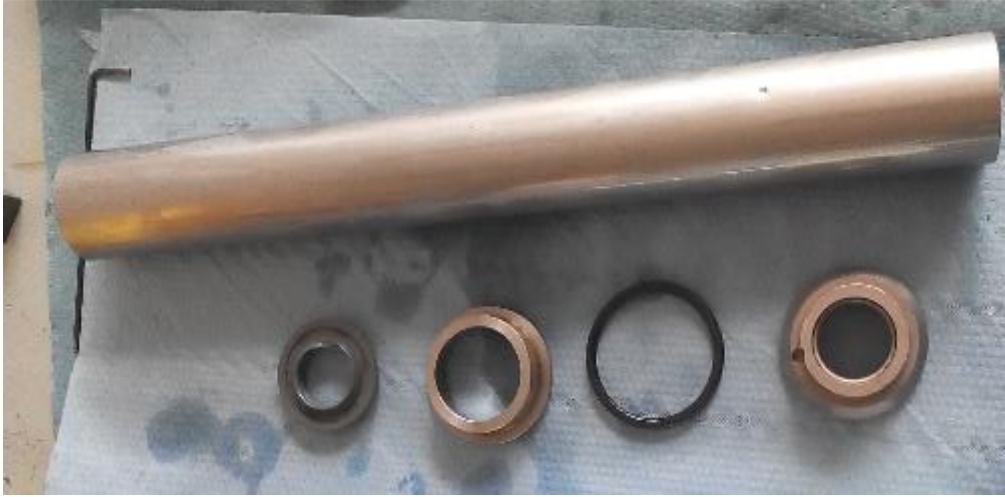
Εικόνα 26 : Κιτ στεγάνωσης. Ροδέλα, τσιμούχα, ρουλεμάν PU.
