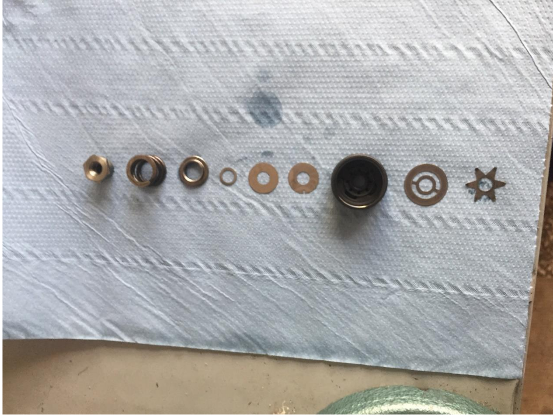
Εικόνα 24 : Εσωτερικά μέρη βαλβίδας βύθισης.
