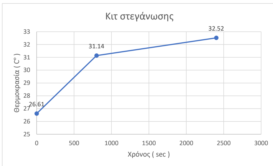
Διάγραμμα 13 : Θερμοκρασιακή διαφορά στο κιτ στεγάνωσης σε διάρκεια 30 δοκιμών για επισκευασμένο αποσβεστήρα με καινούριο λάδι.
