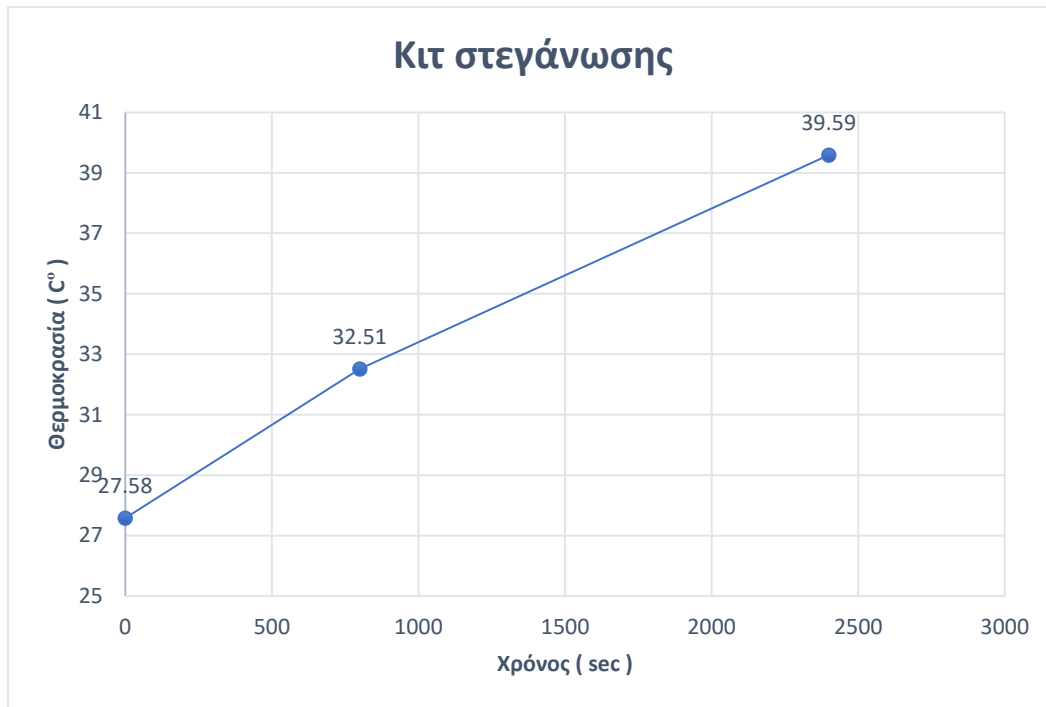
Διάγραμμα 3 : Θερμοκρασιακή διαφορά στο κίτ στεγάνωσης σε διάρκεια 30 δοκιμών για μεταχειρισμένο αποσβεστήρα.
