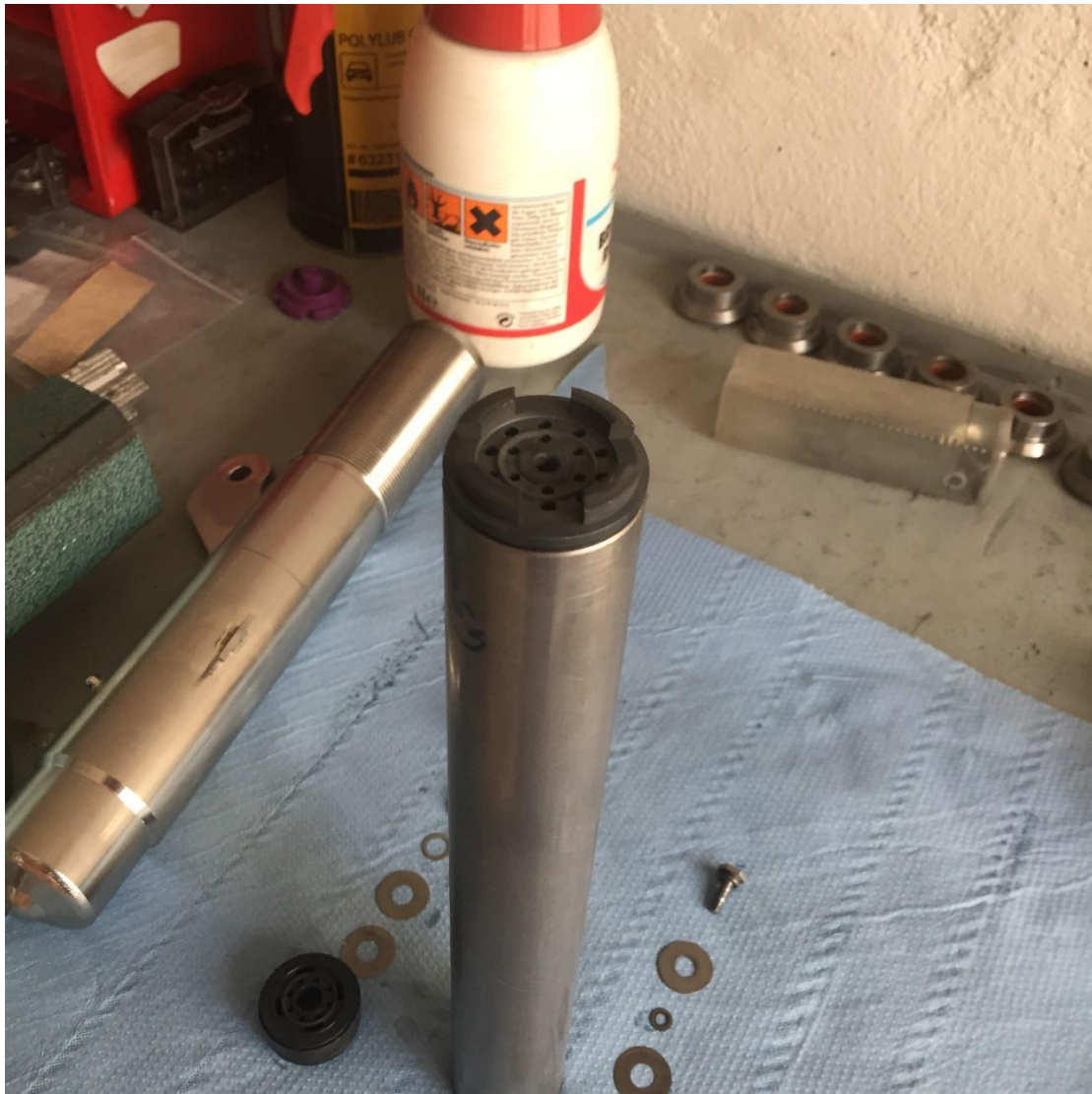
Εικόνα 27 : Βαλβίδα βύθισης η οποία βρίσκεται στο κάτω μέρος του εσωτερικού σωλήνα.
