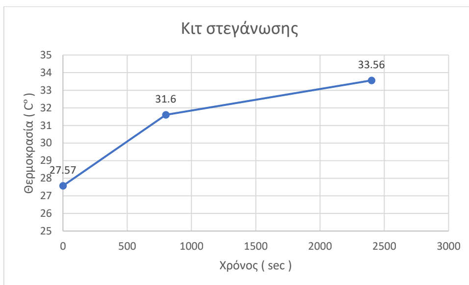
Διάγραμμα 8 : Θερμοκρασιακή διαφορά στο κιτ στεγάνωσης σε διάρκεια 30 δοκιμών για επισκευασμένο αποσβεστήρα με μεταχειρισμένο λάδι.
