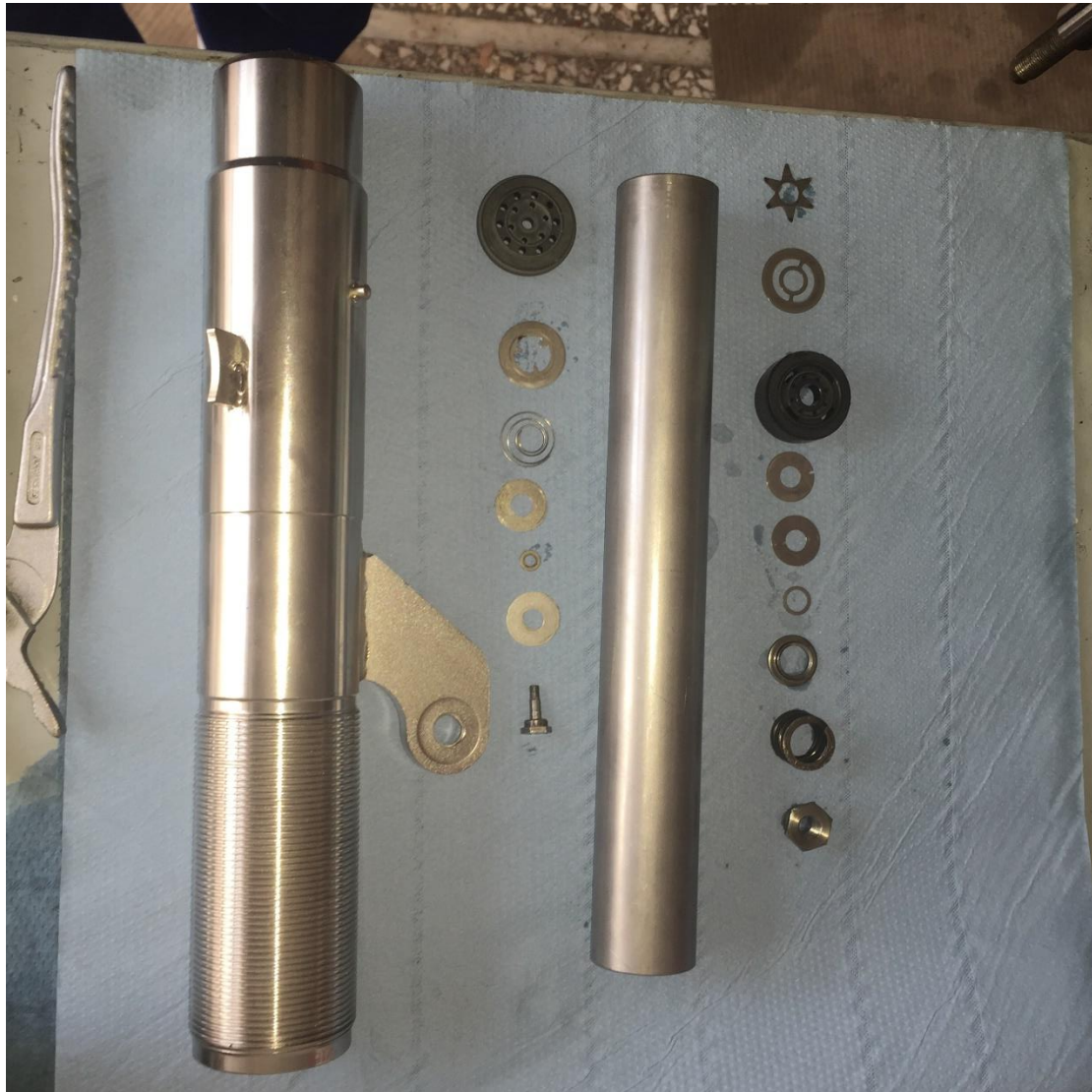
Εικόνα 28 : Εσωτερικά μέρη αποσβεστήρα και εξωτερικός κύλινδρος. Βαλβίδα βύθισης, βαλβίδα επαναφοράς δεξιά.
