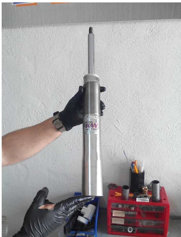
Εικόνα 18 : Αποσβεστήρας πειραματικής διάταξης.
