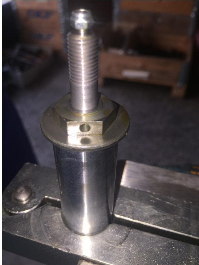
Εικόνα 25 : Βαλβίδα βύθισης. Μέσα από την συγκεκριμένη οπή περνά το λάδι κατά την λειτουργία του αποσβεστήρα. Από το σημείο αυτό μεταβάλλονται οι δυνάμεις της επαναφοράς στην περιοχή των χαμηλών ταχυτήτων ( low speed ) του αποσβεστήρα.
