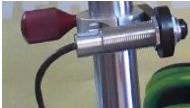
Εικόνα 19 : Αισθητήρας θερμοκρασίας RAC13A.
