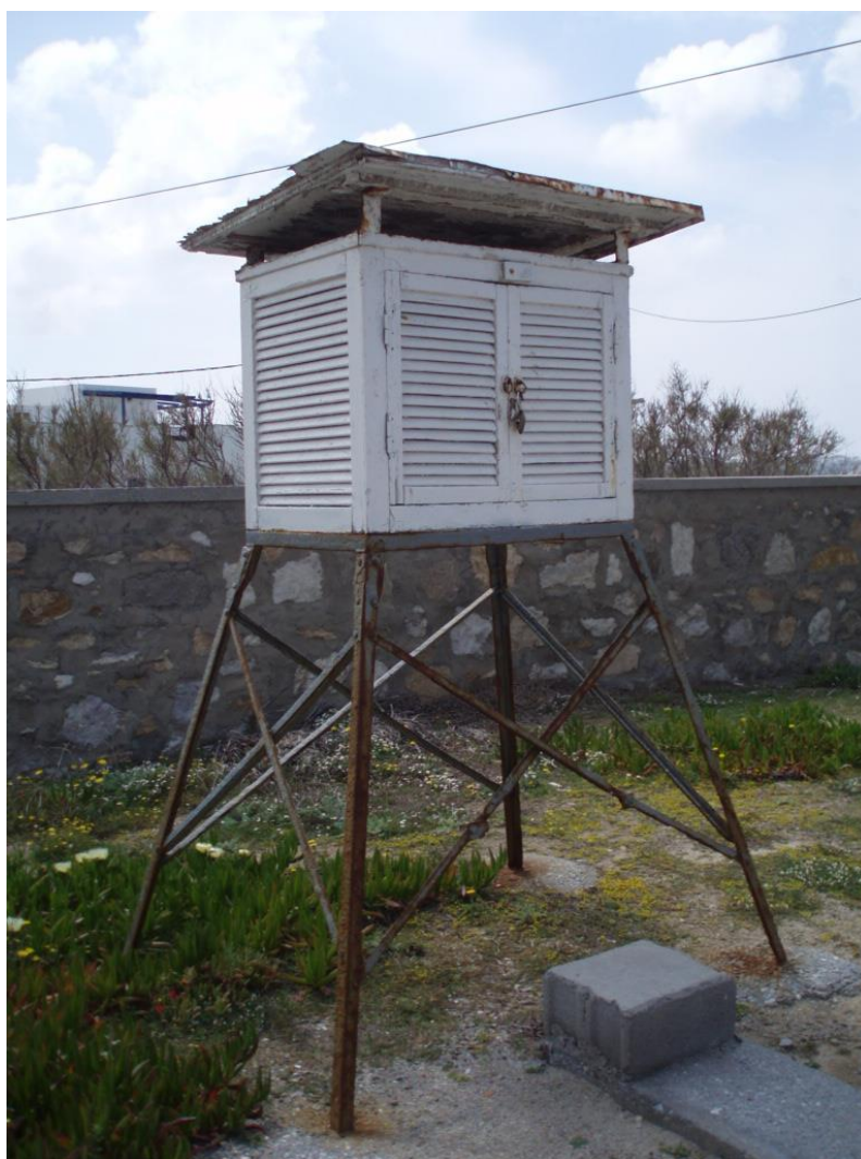
Εικόνα 3: Ο Μετεωρολογικός κλωβός του Μετεωρολογικού Σταθμού Νάξου [4]
