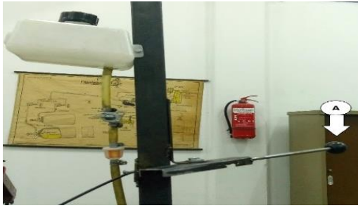
Εικόνα 2.5.16: Μοχλός ρυθμιστή στροφών δυο ταχυτήτων.
