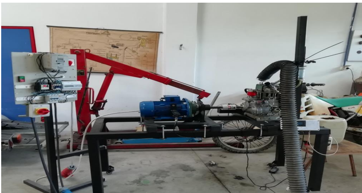
Εικόνα 4.1.5: Ολοκληρωμένη διάταξη δυναμοπέδης.
