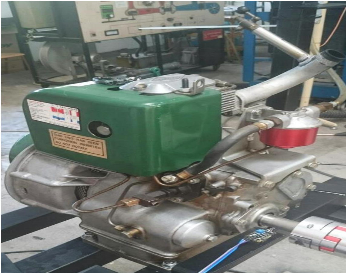
Εικόνα 3.2.7: Πρώτη εκκίνηση κινητήρα Lister Pitter AA1.
