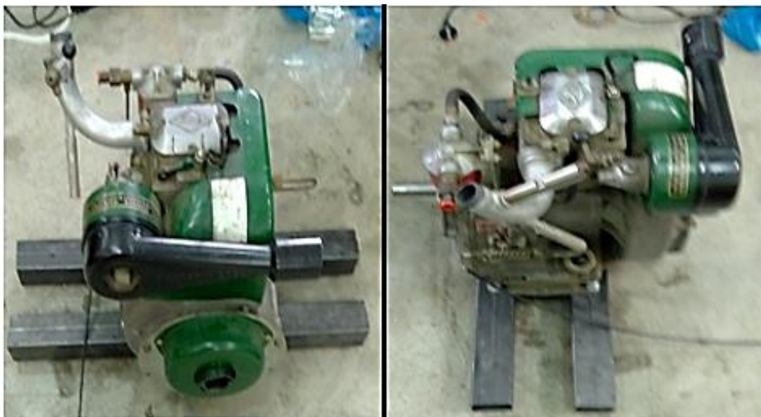
Εικόνα 4.1.2 : Εμπρόσθια και πλαϊνή όψη τοποθετημένης βάσης στήριξης κινητήρα Lister Petter AA1.
