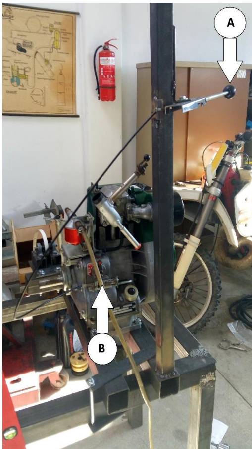
Εικόνα 2.5.17: Σύστημα ελέγχου μοχλού και ρυθμιστή στροφών δυο ταχυτήτων.
