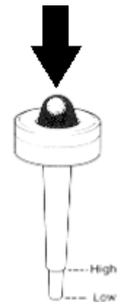
Εικόνα 3.2.2: Φούσκα δείκτη λαδιού. (ix)
