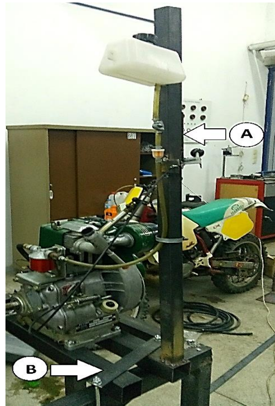
Εικόνα 4.1.4: Τοποθετημένη βάση μηχανής επάνω στην επιτραπέζια βάση.
