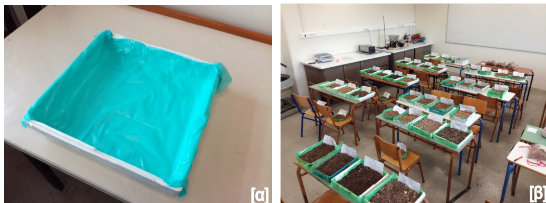
Εικόνα 4.6 Προετοιμασία και τοποθέτηση δειγμάτων σε ταψάκια καλυμμένα με πολυαιθυλενικό υλικό για αεροζήρανση.
