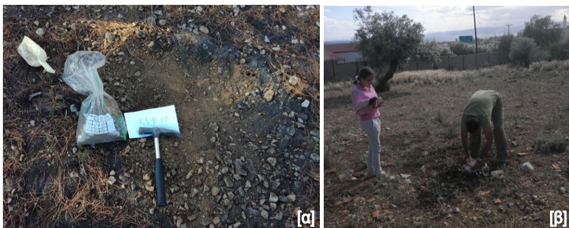
Εικόνα 4.3 Δειγματοληψία επιφανειακού εδαφικού δείγματος.
