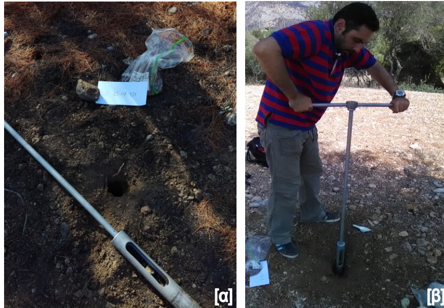
Εικόνα 4.4 (α) Δειγματολήπτης εδάφους (soil auger) και (β) δειγματοληψία εδαφικού δείγματος βάθους 5-25 cm.
