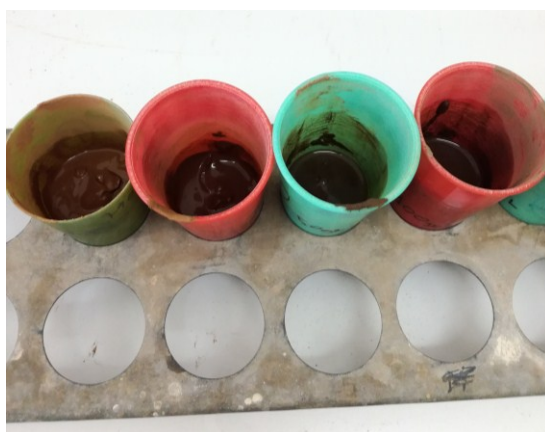
Εικόνα 4.16 Εδαφική πάστα έτοιμη προς μέτρηση pH.
