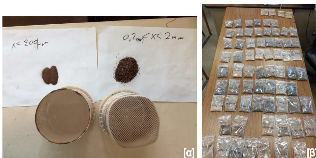
Εικόνα 4.7 (α) Υπόδειγμα τελικού κλάσματος από κάθε κόσκινο και (β) τελικά εδαφικά δείγματα προς ανάλυση.
