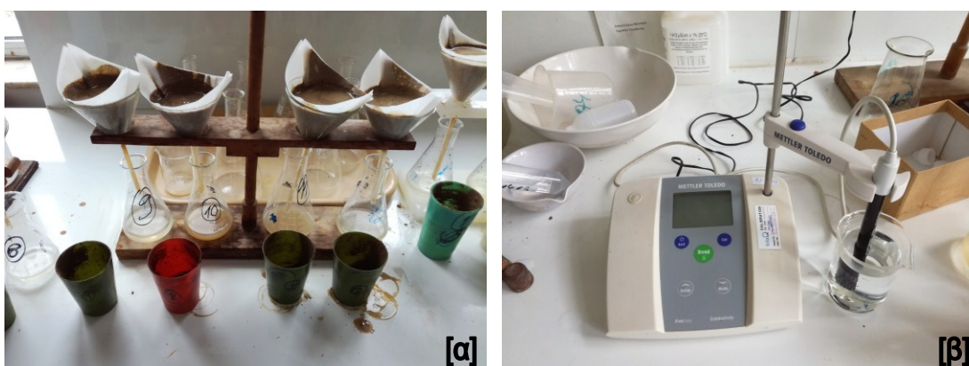
Εικόνα 4.17 (α) Διαδικασία εκχύλισης εδαφικού δείγματος με νερό 1:2 και (β) όργανο μέτρησης αγωγιμότητας (αγωγιμόμετρο) Mettler Toledo FE30 FiveEasy Benchtop Conductivity Meter.
