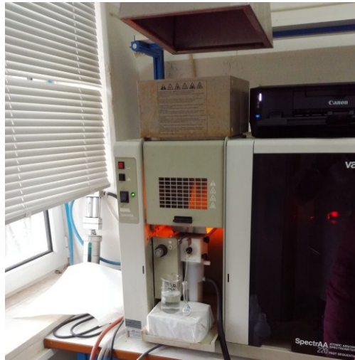
Εικόνα 4.13 Φασματοφωτόμετρο ατομικής απορρόφησης με φλόγα Varian SpectraAA 220 Atomic Absorption Spectrometer εν ώρα μετρήσεως για τον προσδιορισμό των ιχνοστοιχείων Cu, Mn, Fe και Zn.
