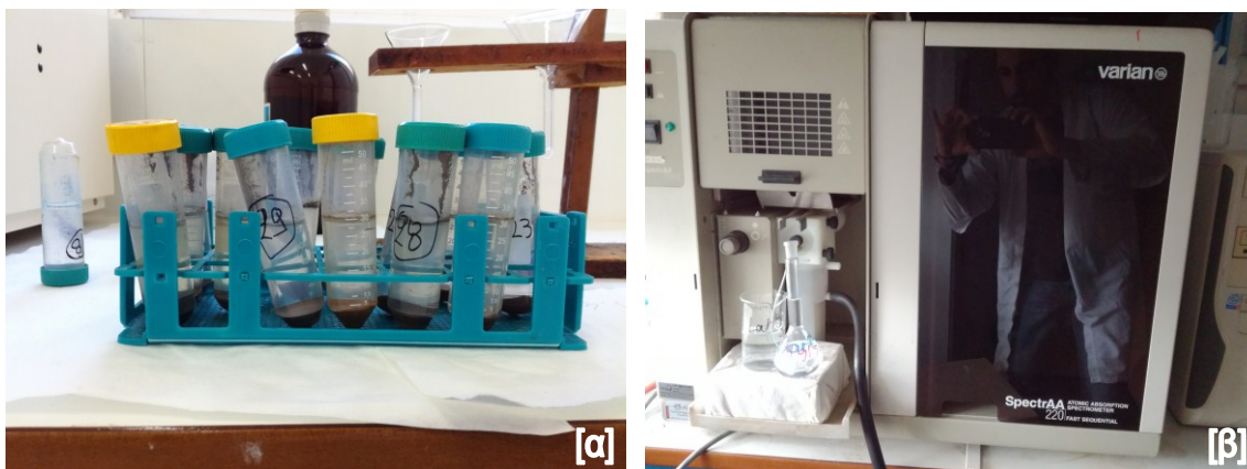
Εικόνα 4.15 (α) Δείγμα κατόπιν φυγοκέντρησης με εμφανές το υπερκείμενο διάλυμα και (β) διαδικασία μέτρησης αραιωμένου διαλύματος σε φασματοφωτόμετρο ατομικής απορρόφησης με φλόγα Varian SpectrAA 220 Atomic Absorption Spectrometer.
