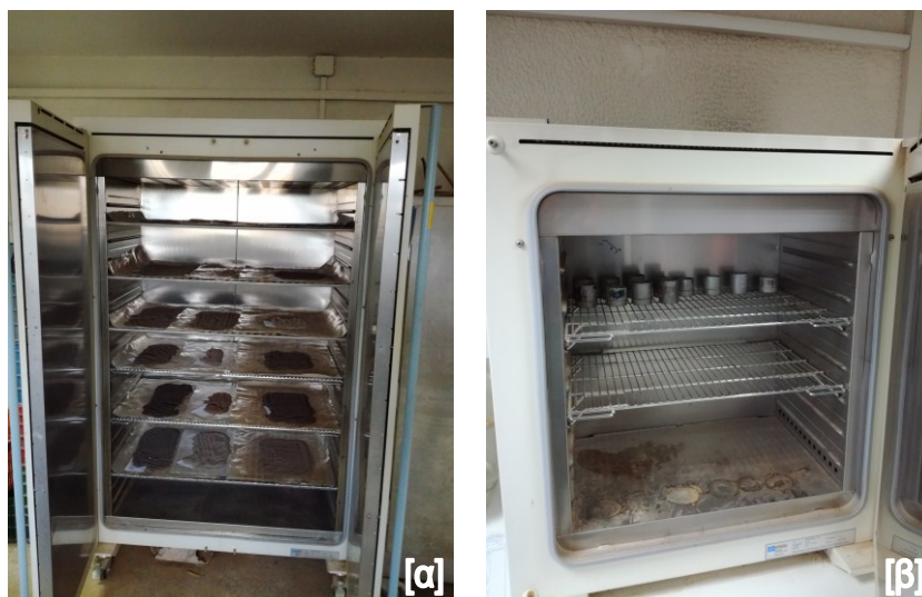
Εικόνα 4.8 (α) Θάλαμος αεροξήρανσης δειγμάτων και (β) φούρνος ξήρανσης μικροδείγματος στον ΕΛΓΟ.
