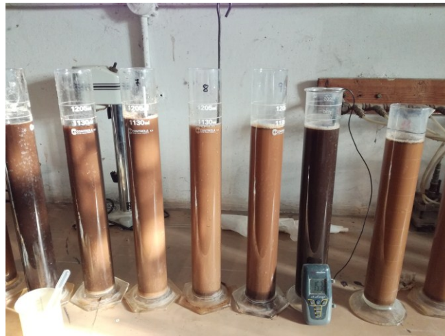
Εικόνα 4.9 Κύλινδροι Βουγιούκου με εδαφικό δείγματα. Στον κύλινδρο Νο7 διακρίνεται το υδρόμετρο, στον Νο8 η ράβδο ανάδευσης και στον Νο10 το θερμόμετρο.
