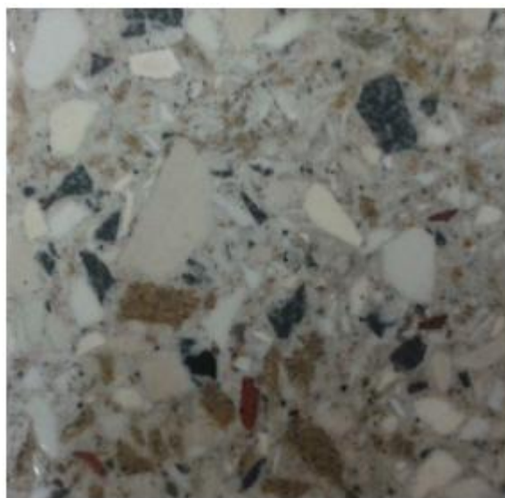
Εικόνα 21 - Δομικό υλικό με πρώτη ύλη ανακυκλωμένα κεραμικά πλακίδια τοίχου. (Πηγή : www.anakem.gr )
