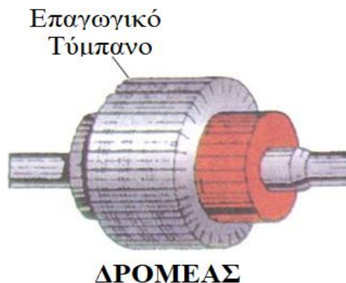
Σχήμα 1.11. Δρομέας μηχανής συνεχούς ρεύματος.
