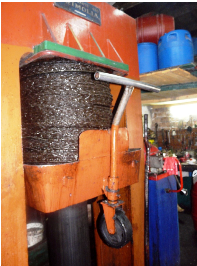
ΕΙΚΟΝΑ 33 πρέσα σε λειτουργία , διακρίνετε και το λάδι που τρέχει .
