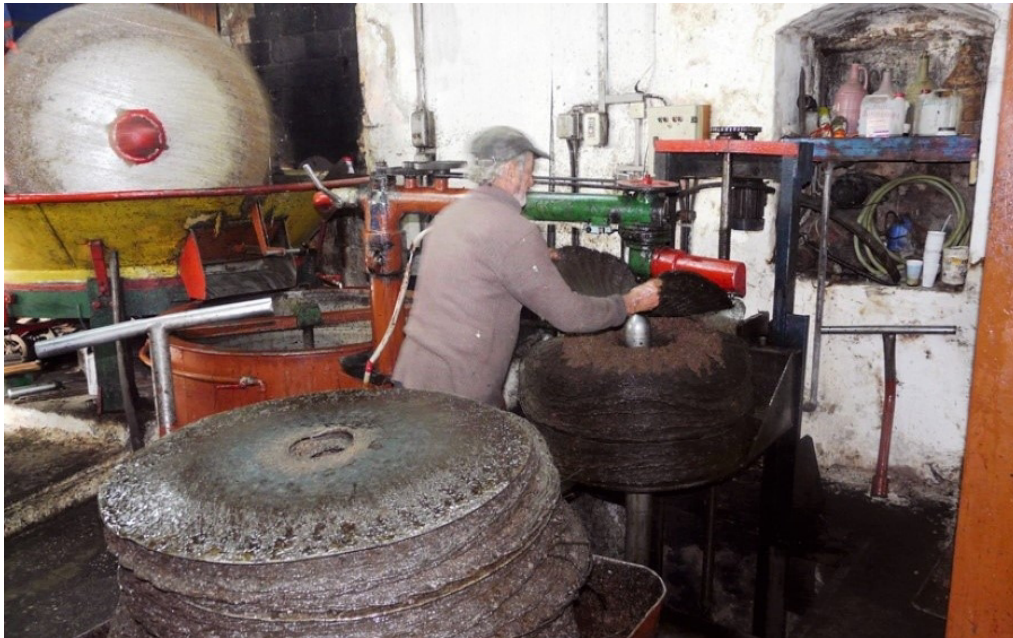
ΕΙΚΟΝΑ 30 φόρτωση καροτσιού , πίσω φαίνεται ο σπαστήρας και ακριβώς δίπλα ένας μικρός μαλακτήρας .
