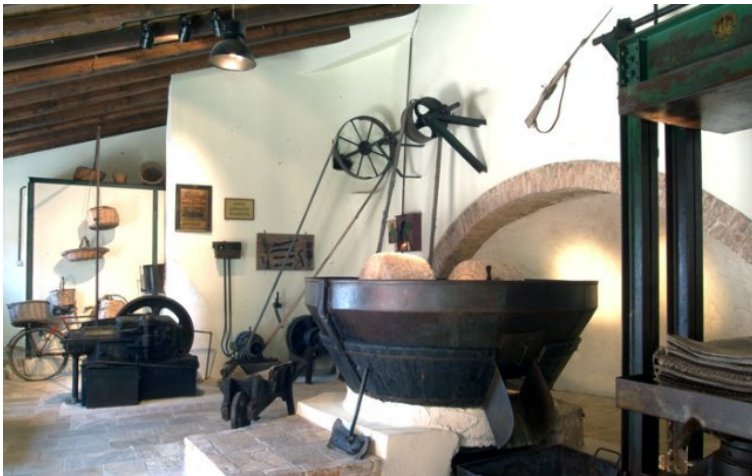
ΕΙΚΟΝΑ 28 ιμαντοκίνητος σπαστήρας στις αρχές των ηλεκτροκίνητων μηχανημάτων.
