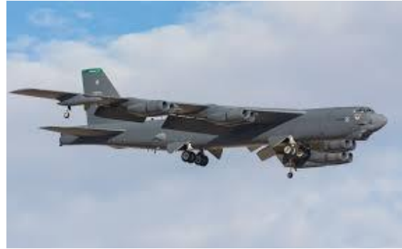
Εικόνα 1.9 Αριστερά το αμερικανικό Lockheed U-2 με δίκυκλο σύστημα και δεξιά το Boeing B-52 με τετράκυκλο σύστημα προσγείωσης.
