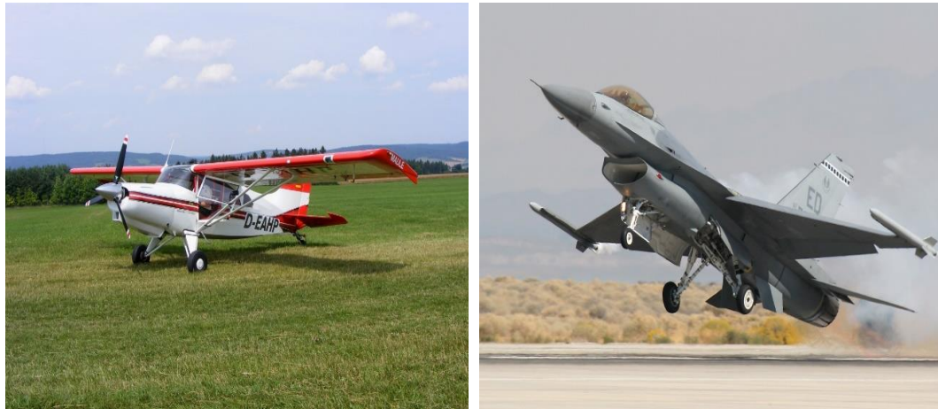
Εικόνα 1.7 Τρίκυκλο σύστημα προσγείωσης. Αριστερά το STOL Maule MX-7-235 Super Rocket με ουραίο τροχό. Δεξιά το στρατιωτικό F-16 με ριναίο τροχό.
