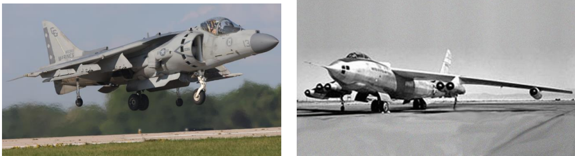
Εικόνα 1.8 Δίκυκλο σύστημα προσγείωσης. Αριστερά το στρατιωτικό Harrier και δεξιά το Boeing B-47 με δύο κύρια σκέλη και βοηθητικά σκέλη κάτω από τις πτέρυγες.
