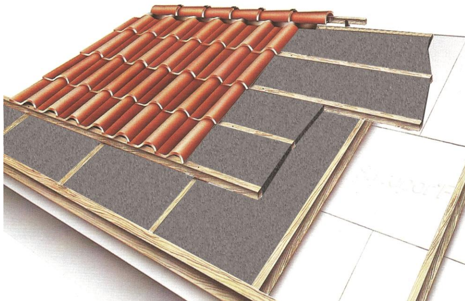
ΕΙΚΟΝΑ 99: ΘΕΡΜΟΜΟΝΩΣΗ ΚΕΡΑΜΟΣΚΕΠΗΣ (WWW.RIZAKOS.GR)
