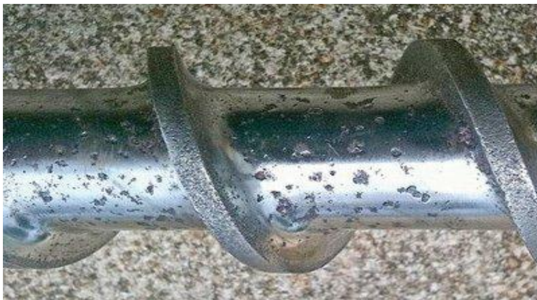
Εικόνα 10: Διάβρωση με βελονισμούς [7]
