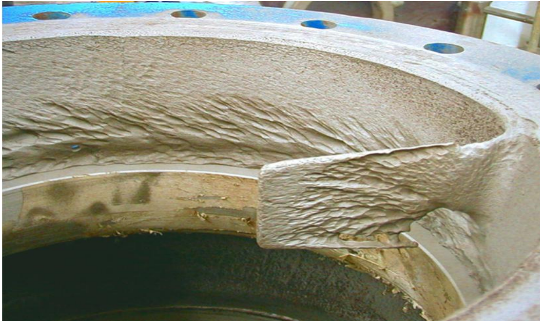
Εικόνα 15: Διάβρωση ρευστού. Σταγονίδια νερού που έχουν προσκρούσει πάνω στα πτερύγια ενός αεροστροβίλου [10]
