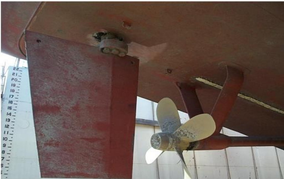
Εικόνα 23: Διάβρωση πηδαλίου και έλικας λόγω θαλασσινού περιβάλλοντος [11]
