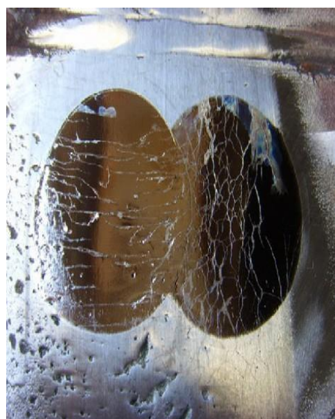
(β) ρωγμές στο σημείο αναπαραγωγής
