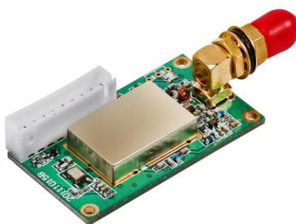
Εικόνα 2.1: Ένα RF module
