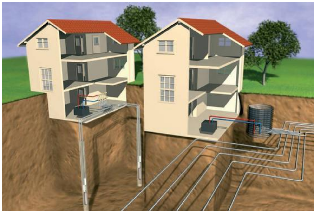
Εικόνα 27. Γεωθερμική εγκατάσταση θέρμανσης-ψύξης
