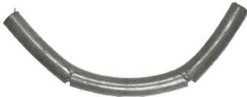
ΕΙΚΟΝΑ 4.1 : Σπασμένη σωλήνα λόγω θερμοκρασίας
