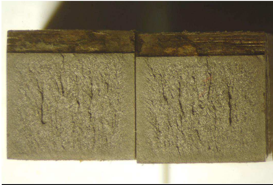
ΕΙΚΟΝΑ 7.3: Επιφάνειες θραύσης δοκιμίου Νο7 (3ώρες ενανθράκωση)
