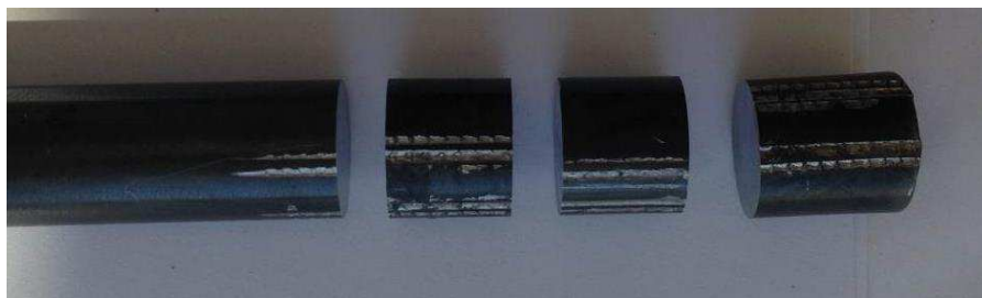
ΕΙΚΟΝΑ 4.7: Κοπή των δοκιμίων για την ανάλυση στην εγκάρσια διατομή
