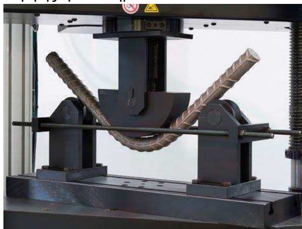
ΕΙΚΟΝΑ 2.13: (α) Μηχανή δοκιμής κάμψης, (β) Πειραματική διάταξη δοκιμής κάμψης
