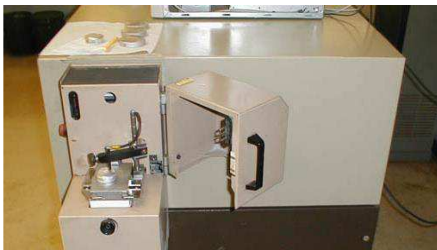
ΕΙΚΟΝΑ 4.2: Θέση Υποδοχής του δοκιμίου στο φασματογράφο
