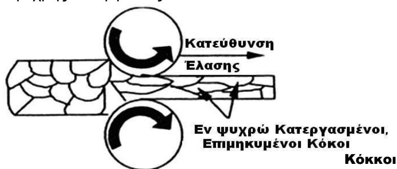
ΕΙΚΟΝΑ 3.3: Πλαστική παραμόρφωση με εν ψυχρώ έλαση [22]
