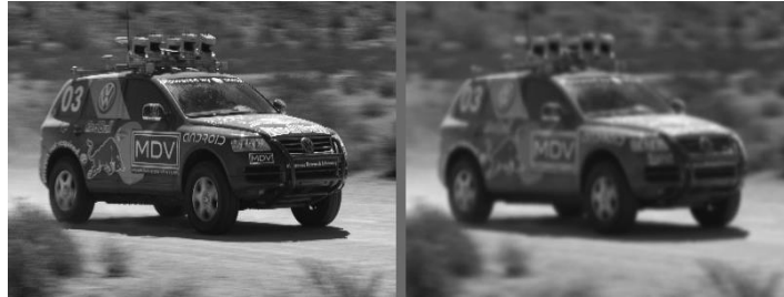
Εικόνα 3.1. Εφαρμογή του Gaussian Blur [1]
