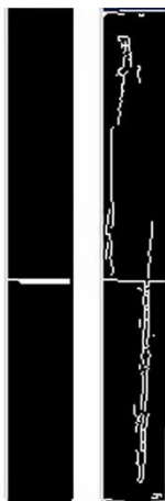
Εικόνα 6.14. Εικόνα Ακρών Με Εφαρμογή Φίλτρου Gauss Και Χωρίς
