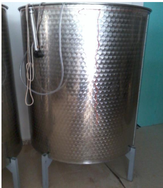
Εικόνα 2.6 Δεξαμενή MARCHISIO INOX Ιταλικής προέλευσης με πνευματικό καπάκι χωρητικότητας 1000 lt. Χρησιμοποιούνται ως αποθηκευτικός χώρος του κρασιού και του μούστου.
