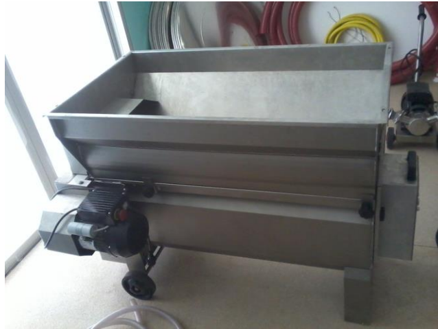
Εικόνα 2.4 Εκκραγηστήρας – διαχωριστήρας Enoitalia τύπου Jolly 35/E ανοξείδωτος (inox), με ανοξείδωτη (inox) αντλία 2,5 Hpr.
