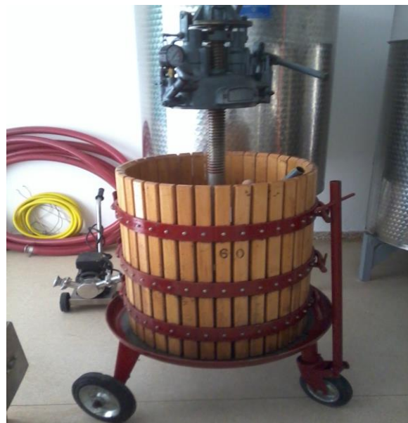
Εικόνα 2.5 Ξύλινο ποτήρι σταφυλιών με υδραυλική πρέσα Φ60. Πιέζει τα στέμφυλα και τα διαχωρίζει από το μούστο.
