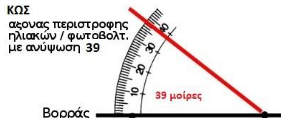
Εικόνα 5.6 Άξονας περιστροφής φωτοβολταϊκών [45]
