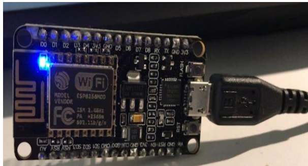
Εικόνα 3.34 Εκτέλεση του προγράμματος "Blink" στον ESP8266 Node MCU
