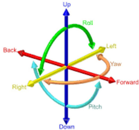
Εικόνα 3.23 Το μαγνητόμετρο δίνει την γωνία yaw (heading).
