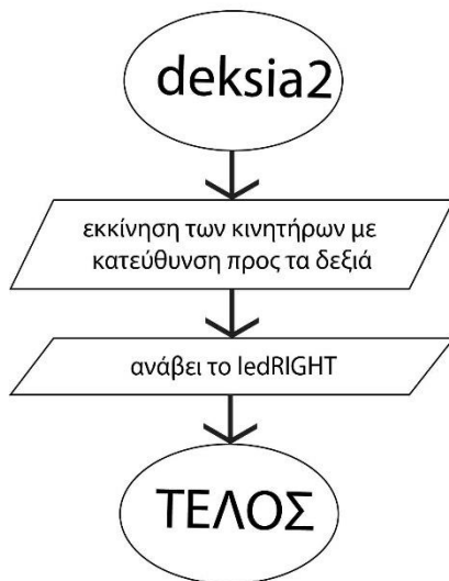
Εικόνα 3.3-13 Διαγράμματα ροής για τις ρουτίνες mprosta2, pisw2, deksia2 και aristera2
