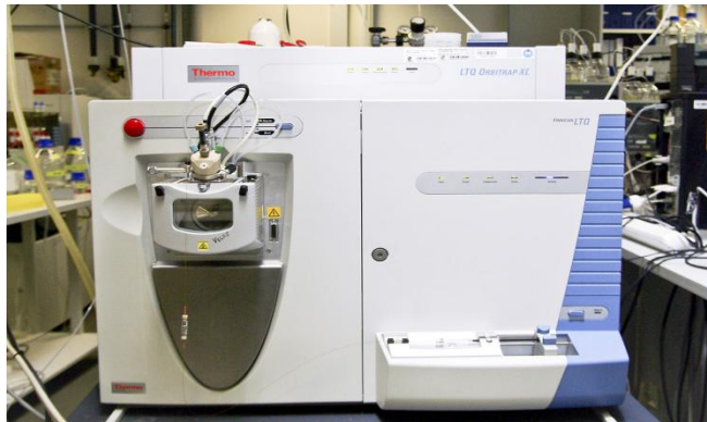
Εικόνα 4.8.: Φασματομέτρο μάζας [xxvii]
