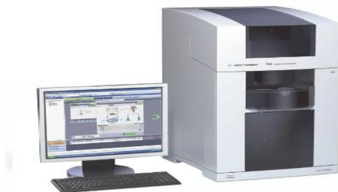
Εικόνα 4.7.: Σύστημα τριχοειδούς ηλεκτροφόρησης [xxv]
