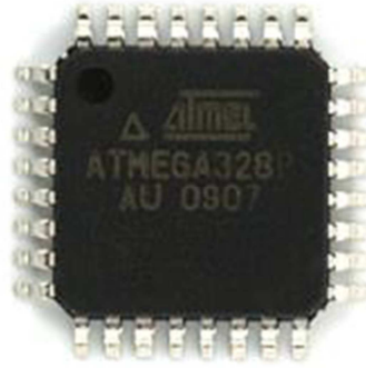
Εικόνα 4.7: Ο μικροεπεξεργαστής ATmega328 σε SMD τύπο
