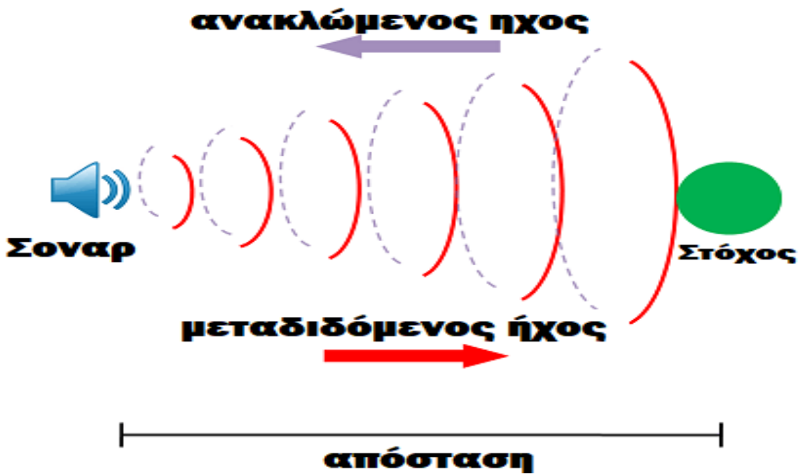
Εικόνα 1.7 Αρχή λειτουργίας ενεργητικού Σόναρ
