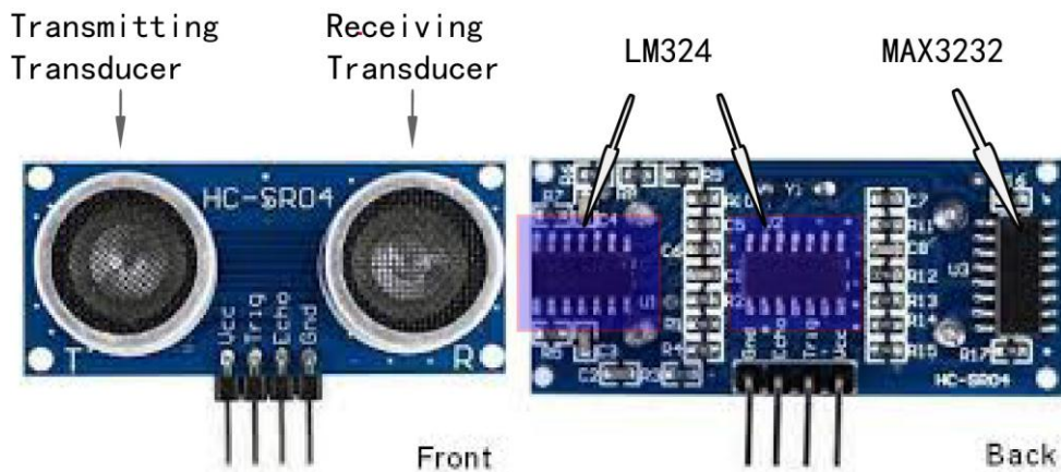
Εικόνα 2.7 Στοιχεία αισθητήρα HC-SR04
