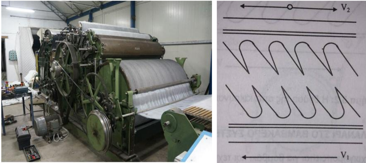
Εικόνα 8 - (α) Μηχανή Λαναρίσματος, (β) Τα οδοντωτά στοιχεία λαναρίσματος
