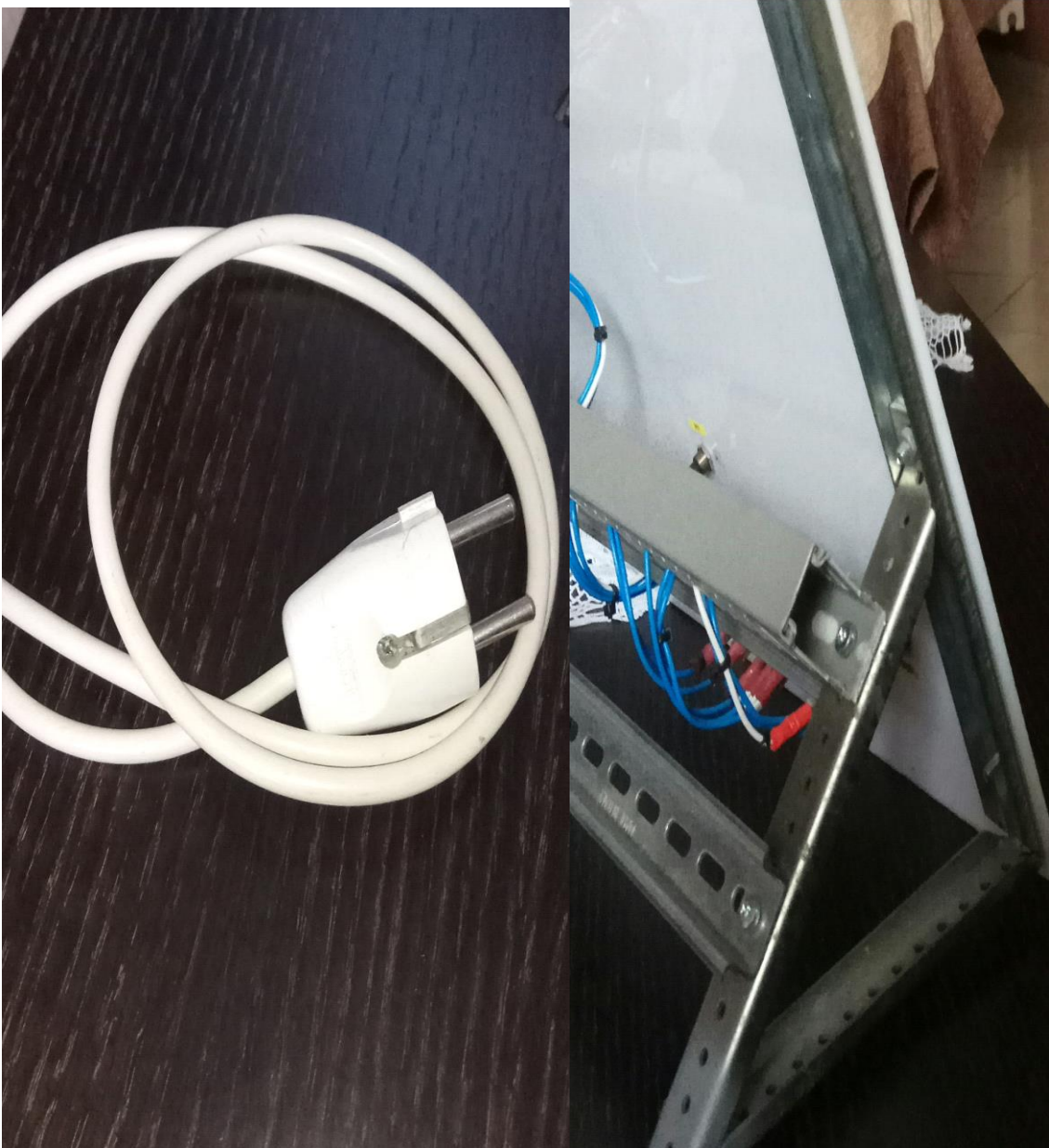
Εικόνα 9 : Φις σούκο + καλώδιο τροφοδοσίας & Μεταλλική κατασκευή για την παροχή τάσης 230 Vac της πινακίδας για τη στήριξη της πινακίδας
