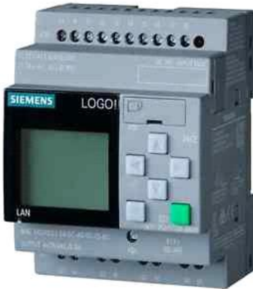
Εικόνα 8: LOGO SIEMENS 6ED1052-1CC01-0BA8, 8 ψηφιακών εισόδων και 4 ψηφιακών εξόδων 24 Vdc (το συγκεκριμένο PLC χρησιμοποιήθηκε για την εκπόνηση τη πτυχιακής)
