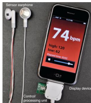
Φωτογραφία 2.4 Ακουστικά με προσαρμοσμένο φωτοαισθητήρα για τη μέτρηση του καρδιακού παλμού (Poh, Kim, Goessling, Swenson, & Picard, 2009)
