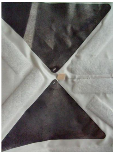
Φωτογραφία 2.21 Κυρτή κεραία (Bowtie) από ύφασμα επικαλυμμένο με σίδηρο (Matthews & Pettitt, 2009)
