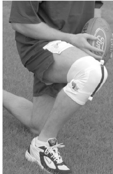
Φωτογραφία 5.1 Ο αισθητήρας τοποθετείται πάνω από την επιγονατίδα και τα ηλεκτρονικά στοιχεία είναι κρυμμένα στην τσέπη (Mattila, 2006)
