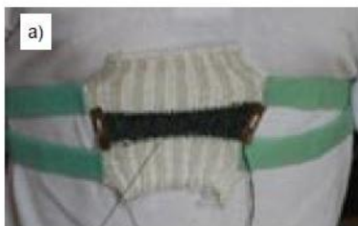
Φωτογραφία 2.15 Ζώνη με ηλεκτρικό και οπτικό αισθητήρα για τη μέτρηση του ρυθμού αναπνοής (Zięba & Frydrysiak, 2006)
