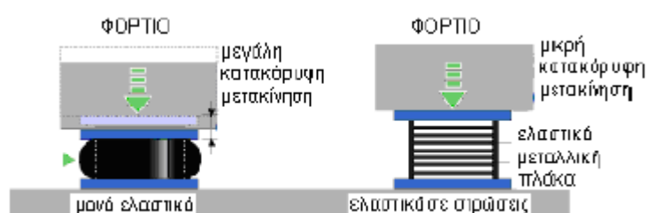
Σχήμα 13. Όσο μειώνεται το πάχος των στρώσεων τόσο αυξάνει η κατακόρυφη δυσκαμψία (www.oiles.co.jp)
