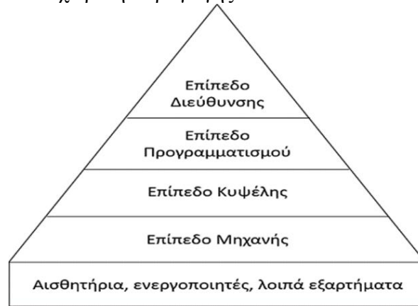
Σχήμα 35. Ταξινόμηση λειτουργιών κατασκευαστικής βιομηχανίας σε ιεραρχικά επίπεδα (προσαρμογή από Χασάπη, 2015).
