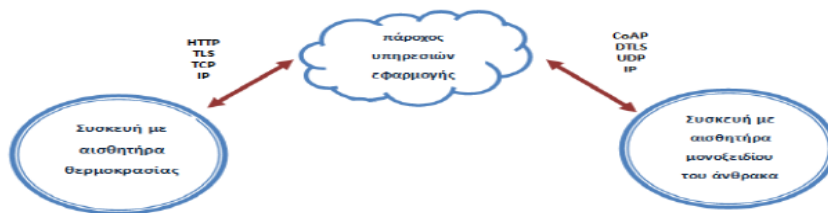
Σχήμα 74. Παράδειγμα μοντέλου Device to Cloud (προσαρμογή από Παπασταθοπούλου, 2017).
