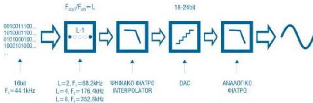
Σχήμα 51. Oversampling διαδικασία αντικατάστασης αναλογικού από ψηφιακό φίλτρο (προσαρμογή από www.avmentor.gr/tech/upsamplers_2.htm ).
