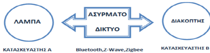
Σχήμα 73. Παράδειγμα μοντέλου Device to Device (προσαρμογή από Παπασταθοπούλου, 2017).
