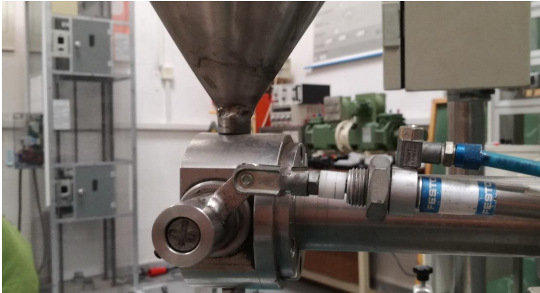
Εικόνα 32 Μηχανικό σύστημα υποστηριζόμενο από πνευματικά εμβολα FESTO
