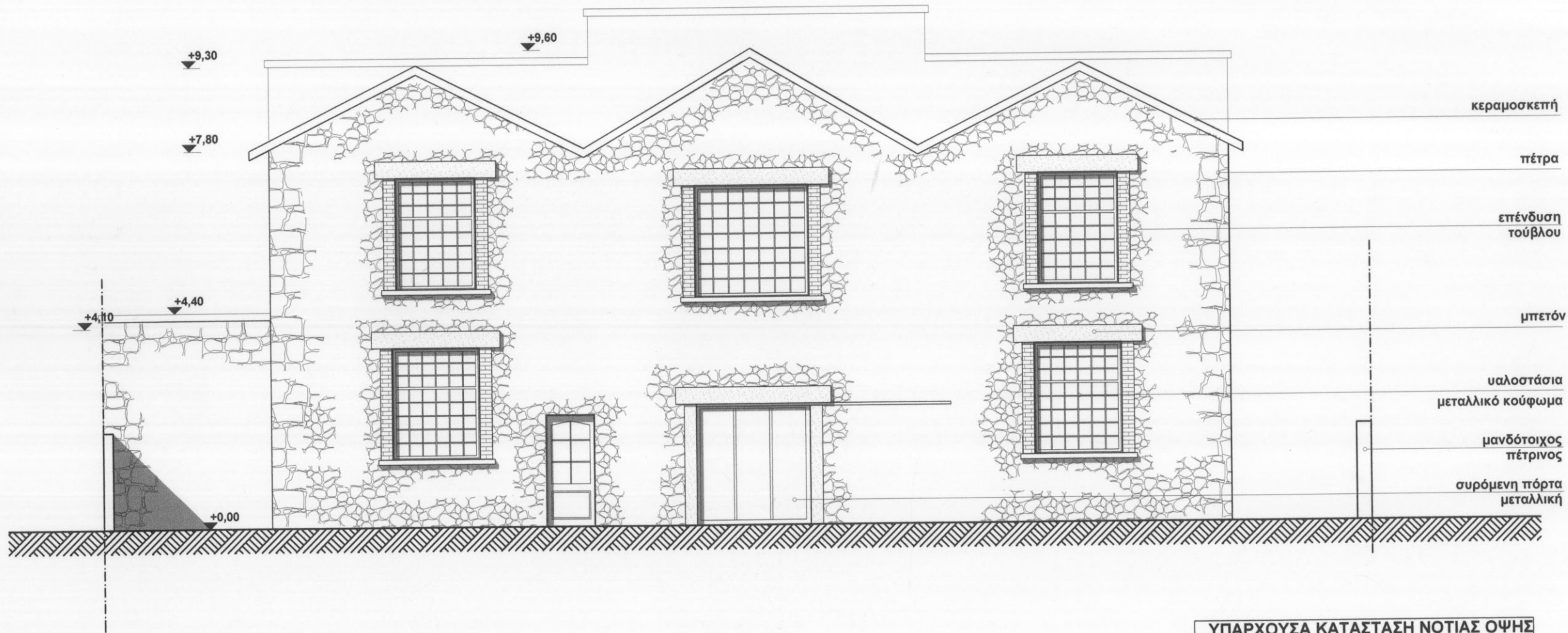
ΥΠΑΡΧΟΥΣΑ ΚΑΤΑΣΤΑΣΗ ΝΟΤΙΑΣ ΟΨΗΣ κλίμακα 1:100
