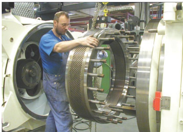
Σχήμα 3.10 Καλούπι κυλινδρικού μύλου που ρυθμίζεται για την πελετοποίηση (πηγή: Kofman, 2007)
