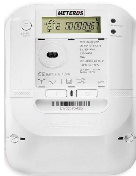
Έξυπνος μετρητής, της εταιρείας EVB Energie AG.
