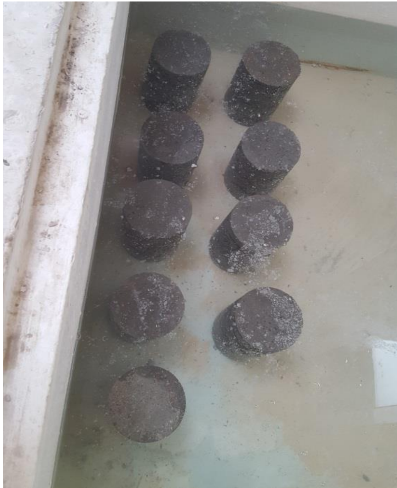
Εικ.10: Δοκίμια τοποθετημένα σε δεξαμενή νερού
