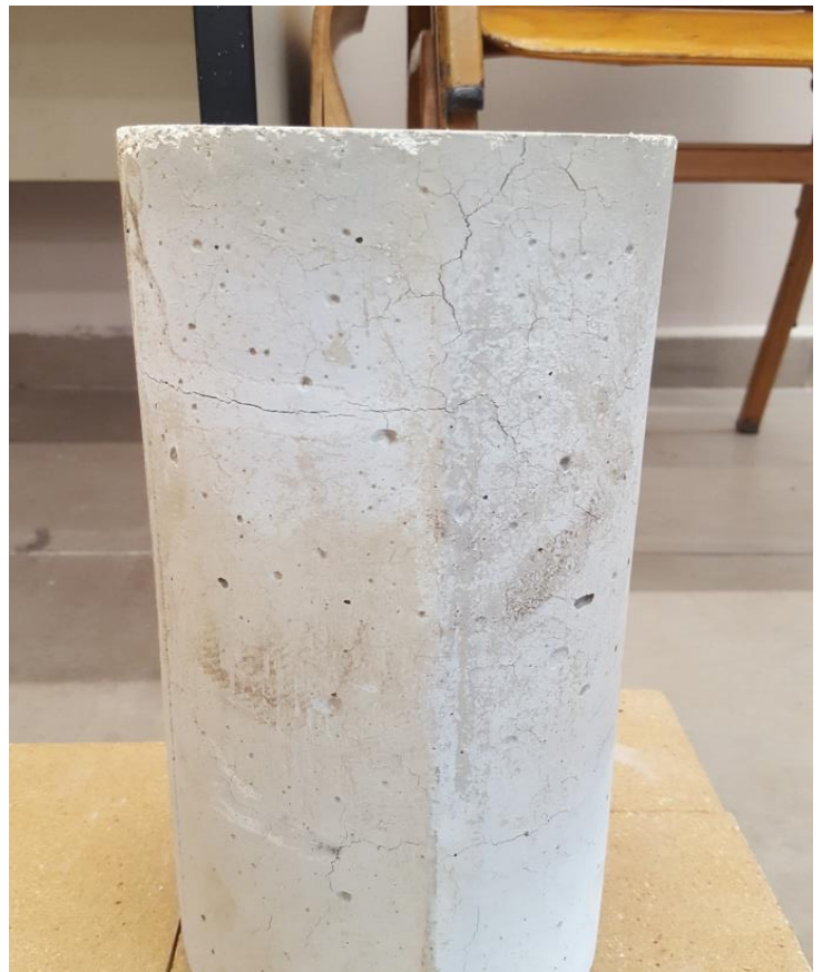
Εικ.22 Έντονες ρηγματώσεις
