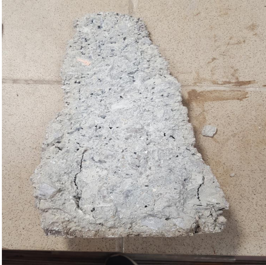
Εικ.23 Δοκίμιο με κενά και πόρους
