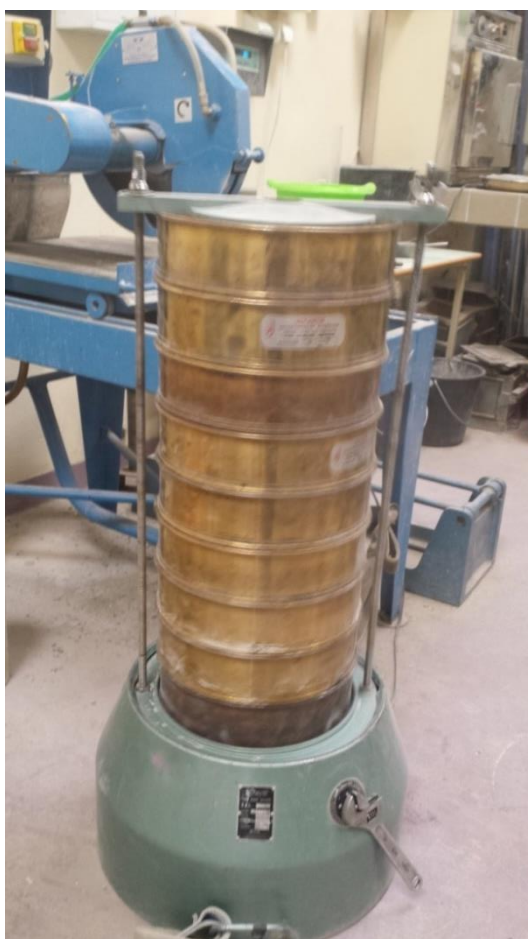
Εικ.1: Αμερικάνικα κόσκινα με την μηχανή κοσκινίσματος
