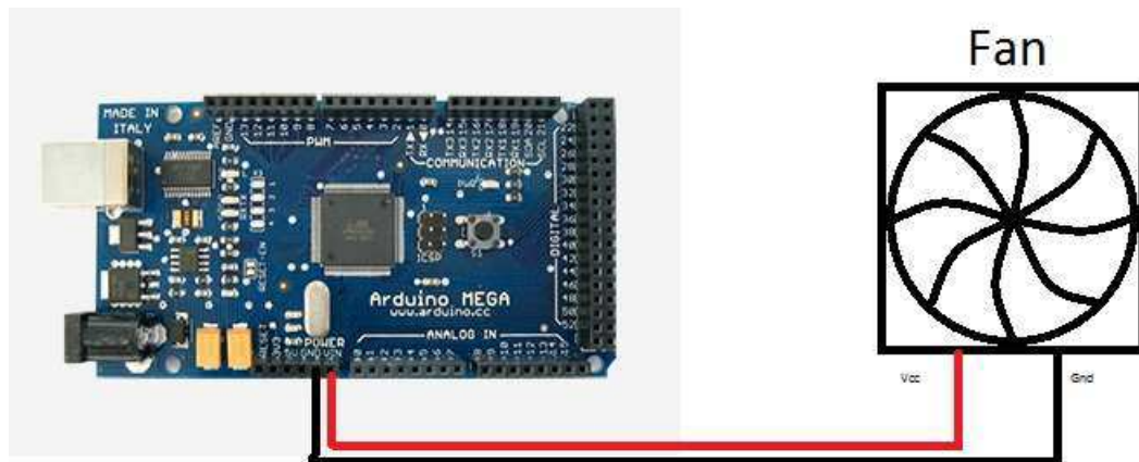
ΕΙΚΟΝΑ 7 ΣΥΝΔΕΣΜΟΛΟΓΙΑ ΑΝΕΜΙΣΤΗΡΑ ΣΤΟ ARDUINO MEGA
