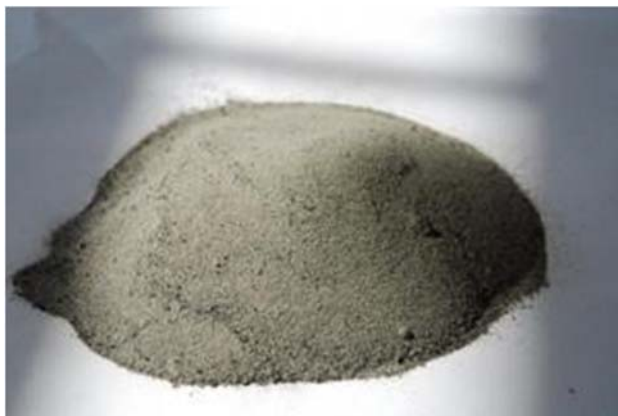
Εικόνα 3: Τεχνητή ποζολάνη, τέφρα
