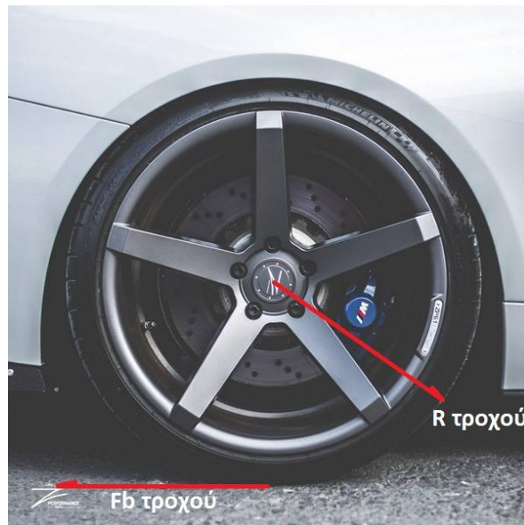
Εικόνα 4.22: Δύναμη ( F_b ) που ασκείται από τον τροχό στο επίπεδο και ακτίνα ( R ) τροχού
