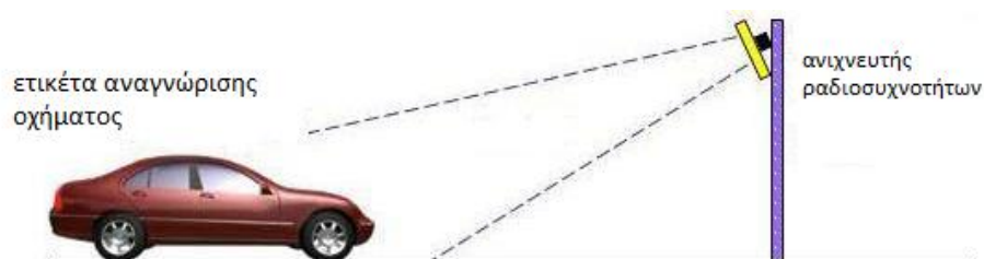
Εικόνα 32: Ανίχνευση οχήματος μέσω ραδιοσυχνοτήτων [47].
