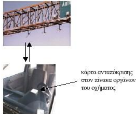
Εικόνα 36: Σύστημα παρακολούθηση με τη βοήθεια καρτών ανταπόκρισης οχημάτων [13].
