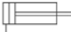
Σχήμα 2.3: Κύλινδρος απλής ενέργειας χωρίς ελατήριο επαναφοράς
