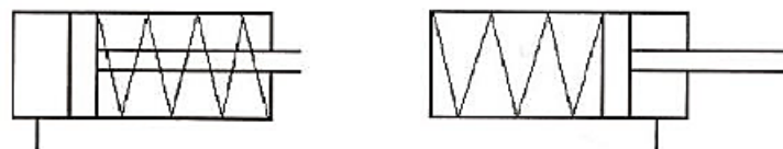
Σχήμα 2.4: Κύλινδρος απλής ενέργειας με ελατήριο επαναφοράς
