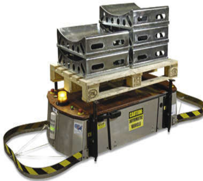
Εικόνα 3.1.2 Guide Tape Navigation AGV[15]
