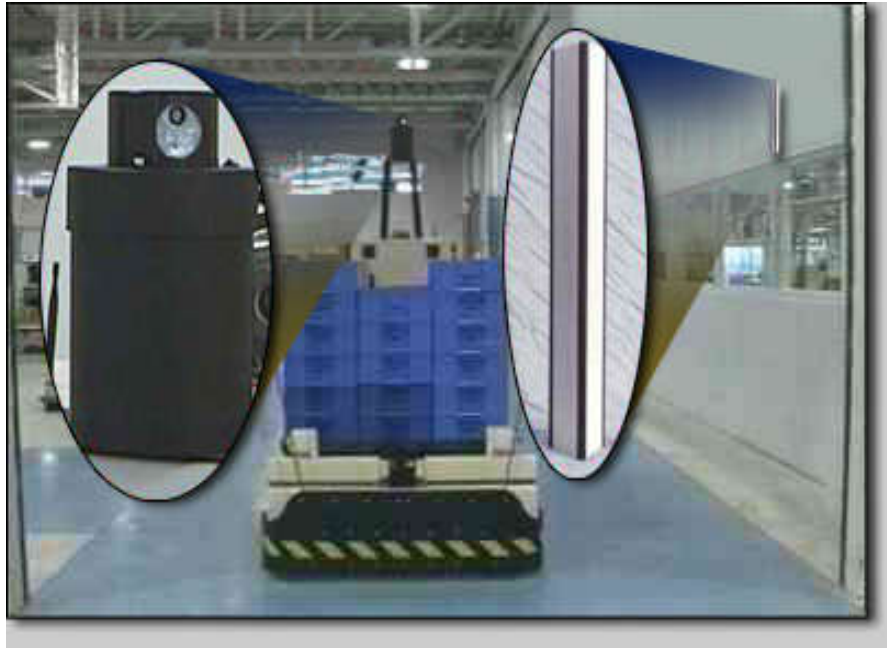
Εικόνα 3.1.3 Laser Target Navigation AGV.
