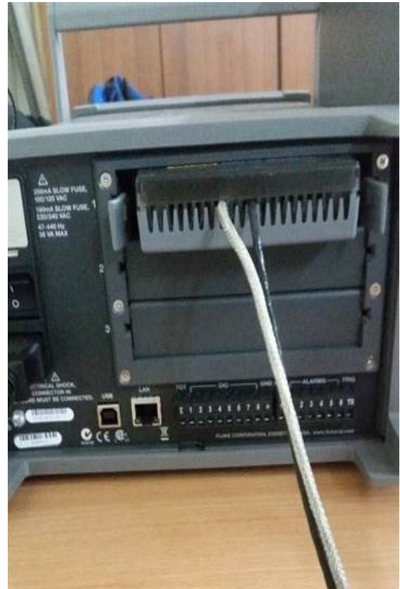
Εικόνα 3.8 Σύνδεση SPRT και Pt-100 σε ειδικό υποδοχέα του οργάνου ανάκτησης.
