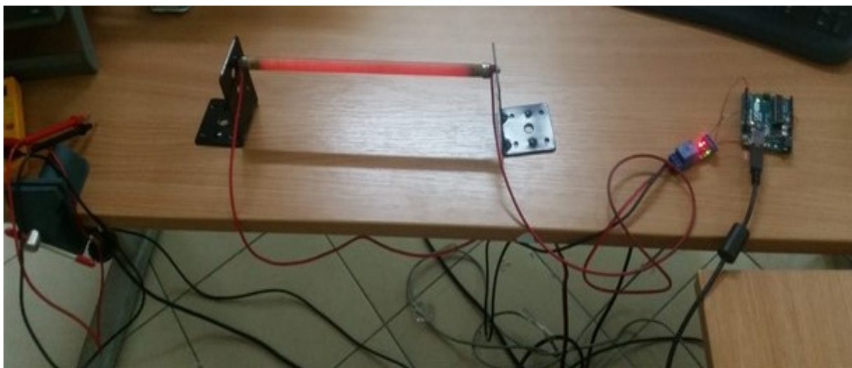
Εικόνα 3.3 Θερμαντική αντίσταση ισχύος 1kW, ενεργοποιούμενη από ARDUINO.
