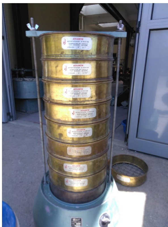
Εικόνα 14 Κοκκομετρική διαβάθμιση του υλικού
