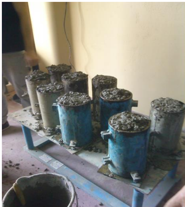
Εικόνα 11 Δόνηση των δοκιμίων στην τράπεζα δόνησης
