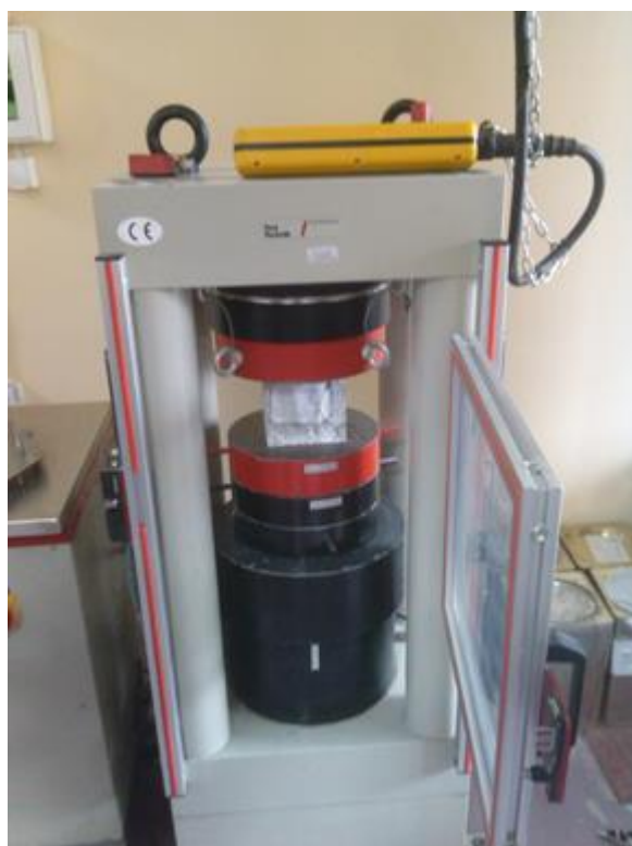
Εικόνα 13 Πειραματική δοκιμή θλίψης ενός τυχαίου δοκιμίου
