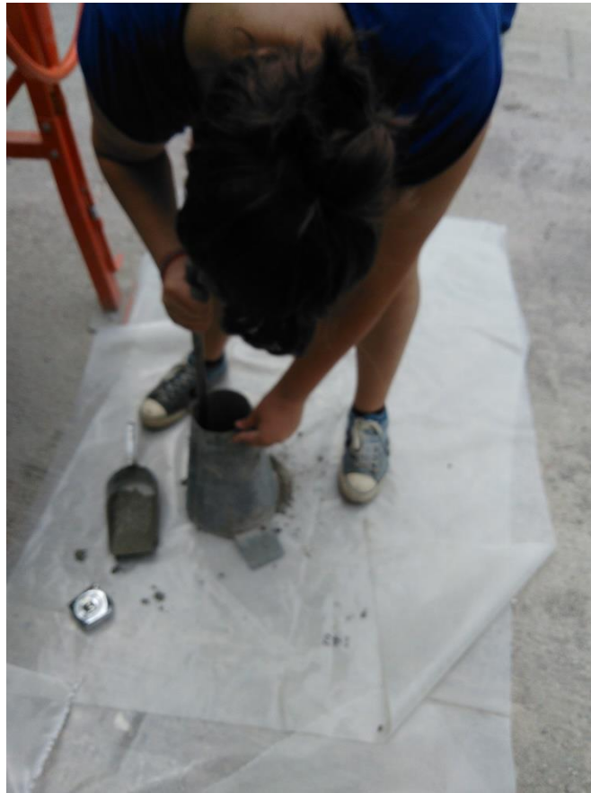
Εικόνα 10 Πειραματικό slump test
