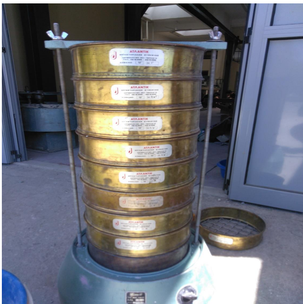
Εικόνα 1 Μηχανή κοσκινίσματος με τα κόσκινα ASTM
