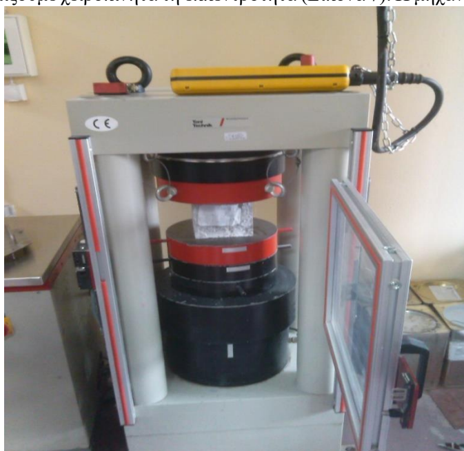
Εικόνα 7 Αναπαράσταση δοκίμιου στην μηχανή θλίψης
