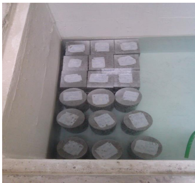
Εικόνα 12 Εμβαπτισμός των δοκιμίων μετά το ξεκαλούπωμα στην δεξαμενή για 7 και 28 ημέρες
